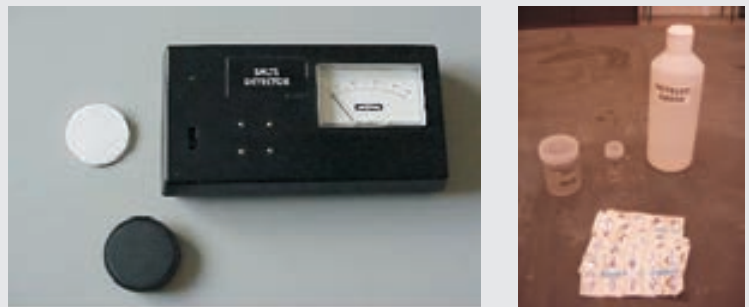
Figura 5 – Detetor de sais e “kit” simples de análise
