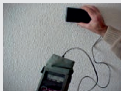
Figura 9 – Inspeção com pacómetro e detetor de corrosão
