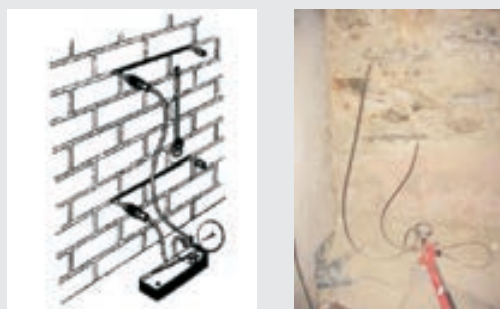
Figura 4 – Esquema de ensaio com macacos planos duplos
