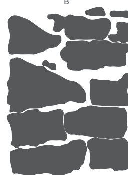
Possível secção transversal da paredes de: (A) um pano; (B) dois panos; (C) três panos
