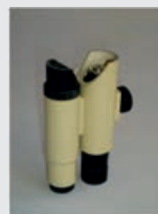
Figura 2 – Fissurómetro e medidor ótico de fissuras
