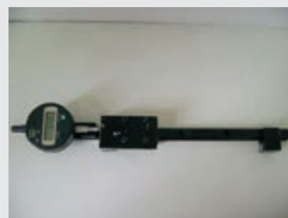
Figura 1 – Esquema do ensaio com o alongâmetro
