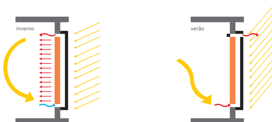
Esquema do funcionamento da Parede Trombe adaptado [Gonçalves, 1997]
