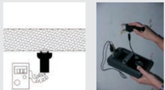
Figura 8 – Medição do teor de humidade em madeira
