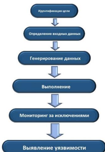
Рисунок 2: Базовая модель фаззера. Адаптировано из [30]
