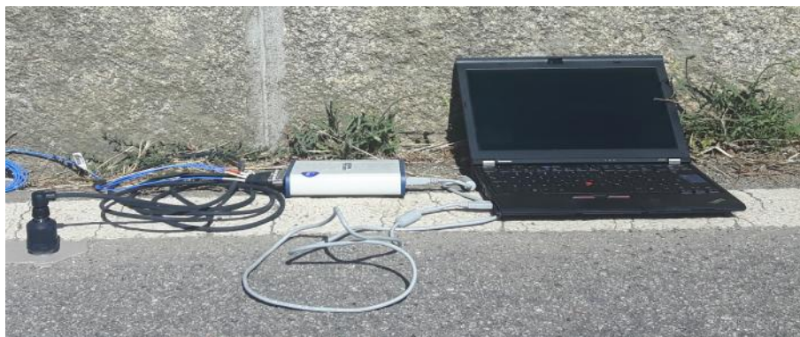
Figura 3 - Equipamento de medição durante realização de ensaio uniaxial.
