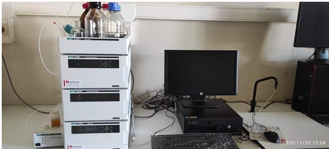
Figura 16: Registro fotográfico do equipamento HPLC (high performance liquid chromatography) usado ao longo deste trabalho.
