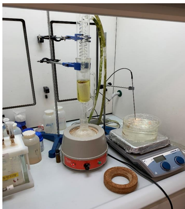
Figura 18: Extração em Soxhlet do shell em Acetonitrilo/Dimetilformamida (50/50)
