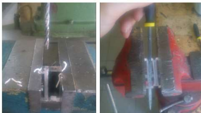
Figura 7- Perforación del acrílico con el taladro industrial FF1 (a la izquierda) y limadura de los canales del separador de los electrodos (a la derecha).
