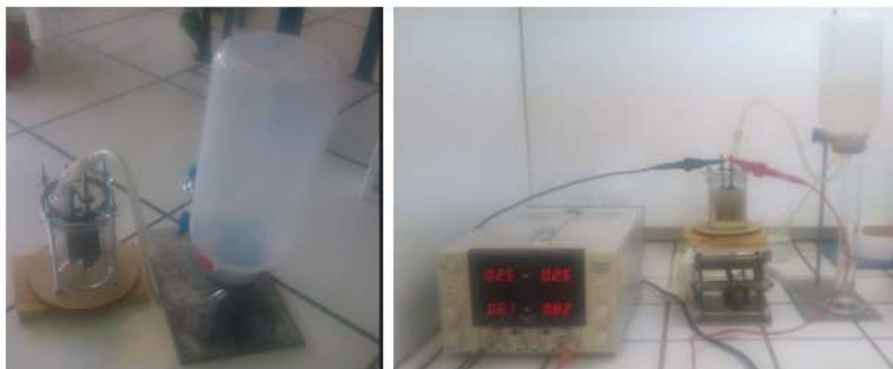
Figura 11- Cuarto prototipo de célula de electrólisis (a la izquierda) y montaje del sistema (a la derecha).
