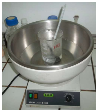
Figura 20- Decapado con HCl \approx 1\text{mol/L} y calentado a Baño María.
