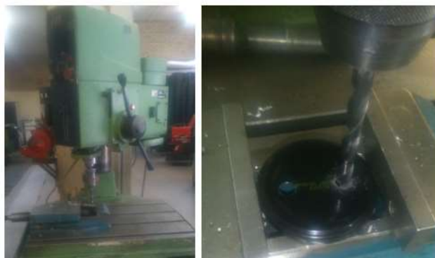
Figura 4- Taladro industrial FF1 (a la izquierda) y perforación de la tapa de la célula de electrólisis (a la derecha).
