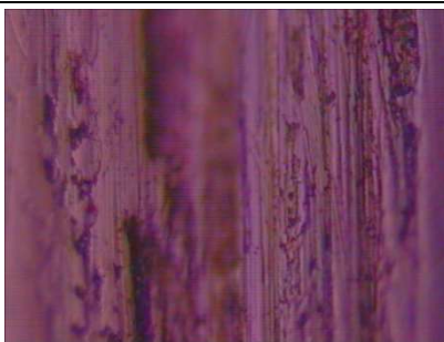
Figura 34- Porosidad del electrodo 420 MC en su estado natural-Nikon JAPAN (50x).
