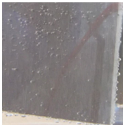
Figura 38-Burbujas pegadas en la superficie del electrodo 304 L.
