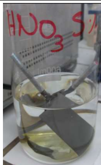
Figura 22- Decapado de los electrodos con HNO 3 al 5%.
