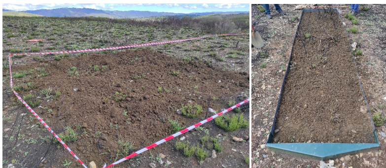
Fig. 9. Aplicação de tecnossolo sob área ardida e parcela de erosão na área de estudo Aveleda. Foto: Ana Royer, 2021.
