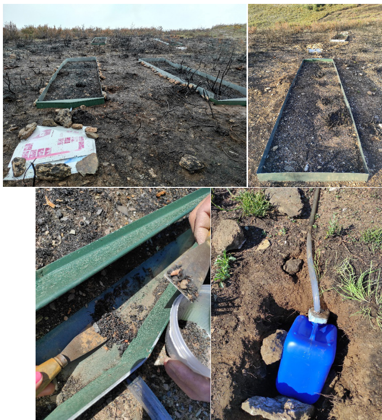
Fig. 7. Parcelas de erosão e colheita de escoamento e sedimentos nas frentes das parcelas instaladas após o fogo na parcela de Aveleda. Foto: Ana Royer, 2021.
