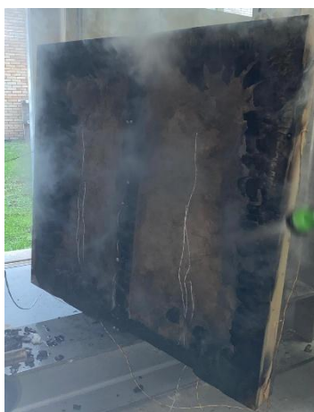
Figura 48. Face exposta imediatamente após o Ensaio 1.
