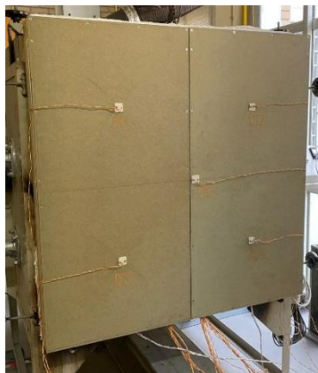
Figura 35. Lado não exposto instalado na estrutura do forno, correspondente ao modelo de parede LWF ensaiado (Ensaio 1).
