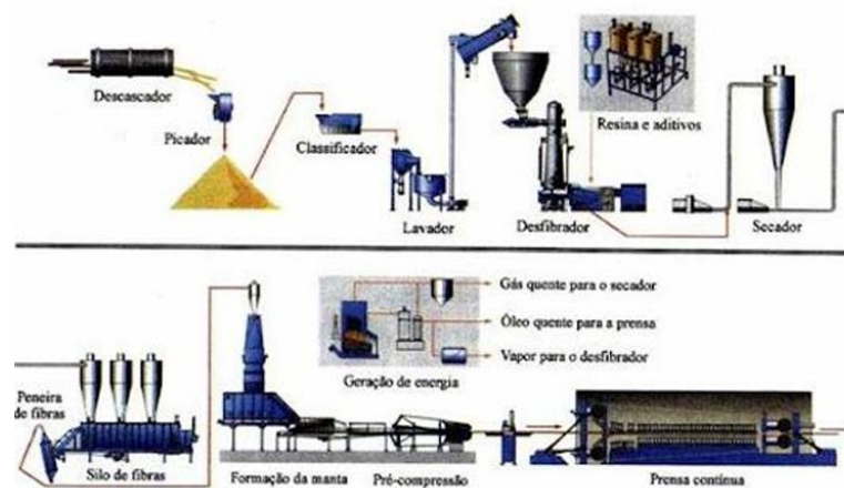
Figura 14. Processo de produção industrial do MDF, [25].
