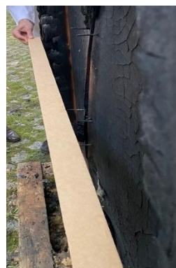
Figura 61. Medição da deformação do painel com régua rígida no lado não exposto.
