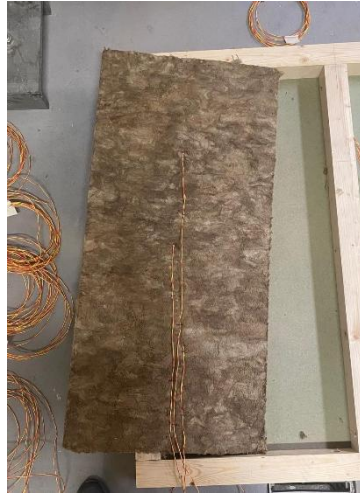
Figura A15: Instalação dos termopares de interface na lã de rocha durante o Ensaio 1.
