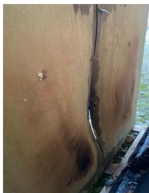
Figura 60. Deformação côncava do MDF no lado não exposto após o Ensaio 2.
