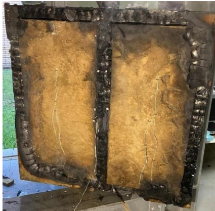
Figura 57. Face exposta do painel após o Ensaio 2.
