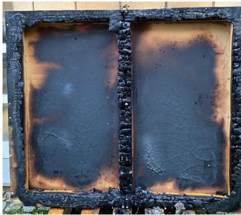
Figura 53. Interior da cavidade após remoção da lã de rocha (Ensaio 1).
