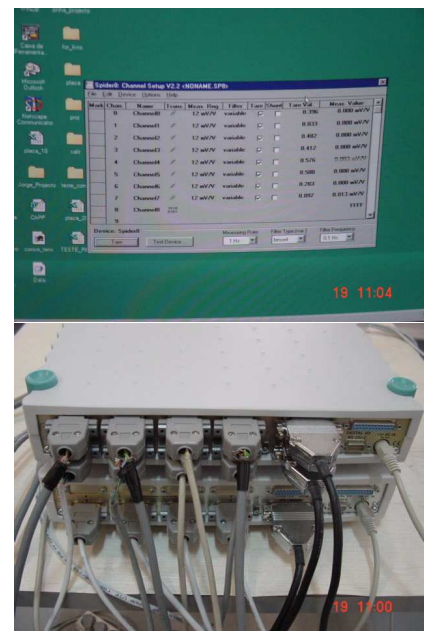
Figura 8: Sistema SPIDER8 de medição com 12 canais.
