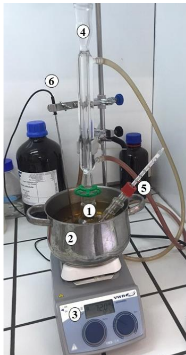
Figura 11. Montagem experimental utilizado na reação de transesterificação para produção de biodiesel.
