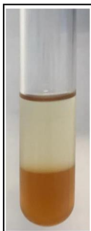
Figura 45. Teste E3. 1:1 (v/v) EtOAc/água, 1:4 (w/w) fase catalisadora/mistura de solventes.
