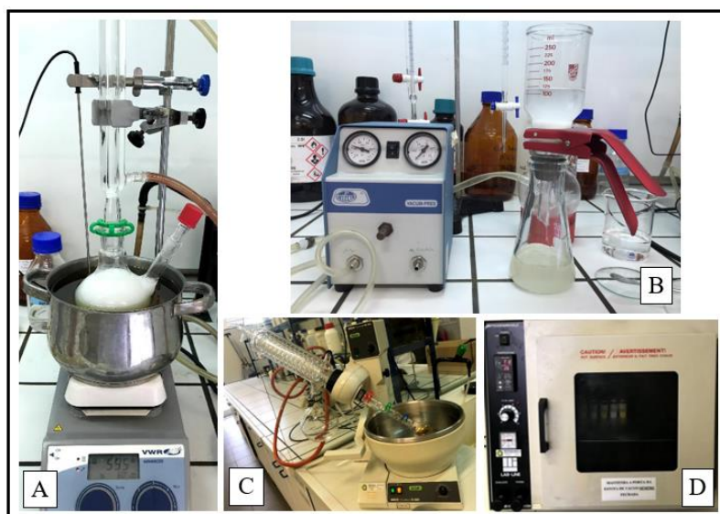
Figura 10. Montagem experimental utilizada na produção do hidróxido de colina: (A) Reator; (B) Sistema de filtração; (C) Evaporador rotativo; (D) Estufa a vácuo.
