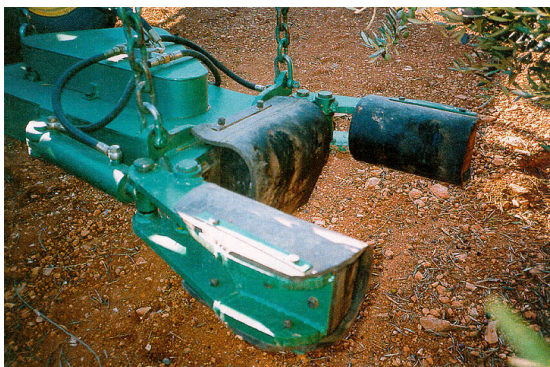
Figura I-26 - Pinças com as almofadas que agarram a árvore.
