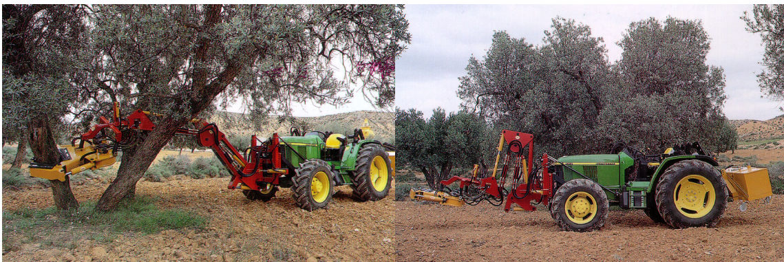
Figura I-21 - Estrutura de suporte extensível. À esquerda, na configuração estendida, chegando ao tronco; à direita, na configuração recolhida.
