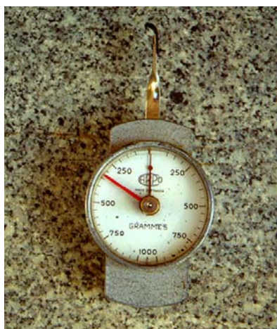
Figura IV-30 - Dinamómetro utilizado para medição da força de destaque dos frutos (R).
