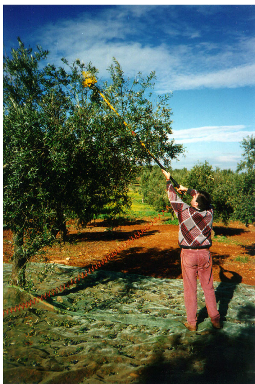
Figura I-7 - Vibrador portátil do tipo “bate-palmas”.
