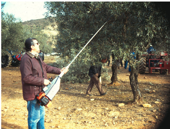
Figura I-5 - Vibrador portátil com vara equipada com gancho.
