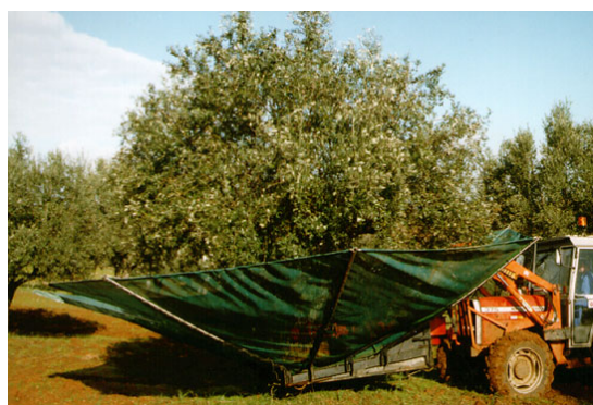
Figura I-38 - Aparafritos para interceptação e recolha mecânica dos frutos.
