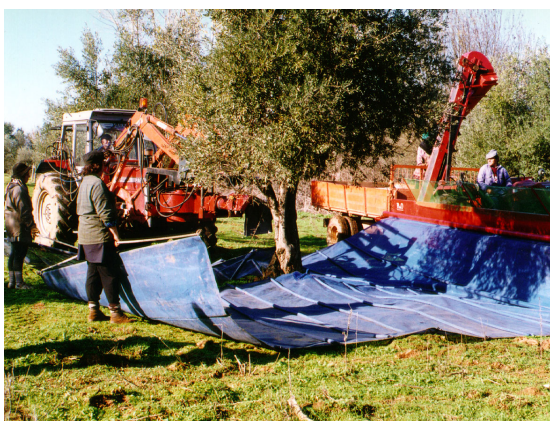
Figura I-35 - Enrolador de panos para interceptação e recolha mecânica dos frutos.
