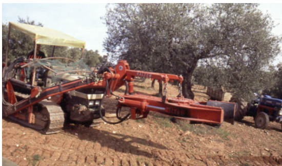
Figura I-17 - Vibrador montado na dianteira do tractor.
