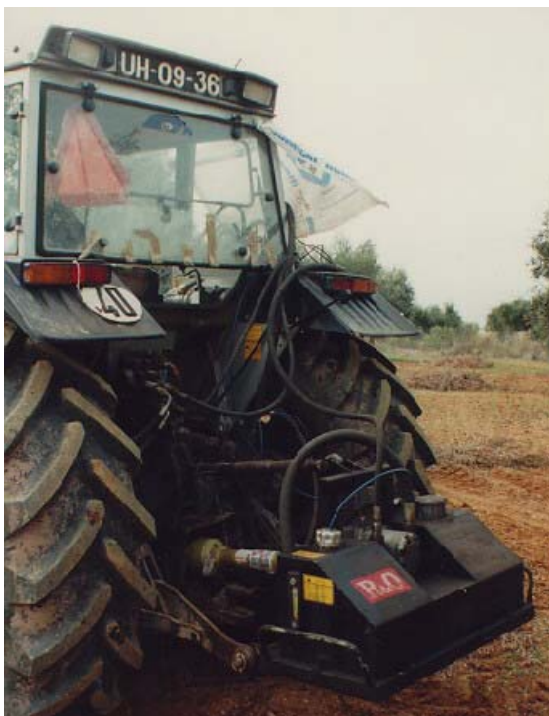
Figura IV-15 - Conjunto bomba, multiplicador de velocidade e depósito de óleo.
