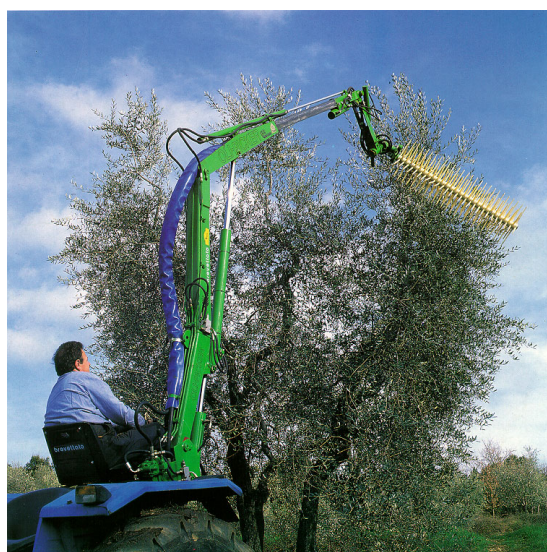
Figura I-27 - Colheita mecânica por acção de um rotor munido de varas flexíveis. Fonte: catálogo comercial “Oli-Picker”.
