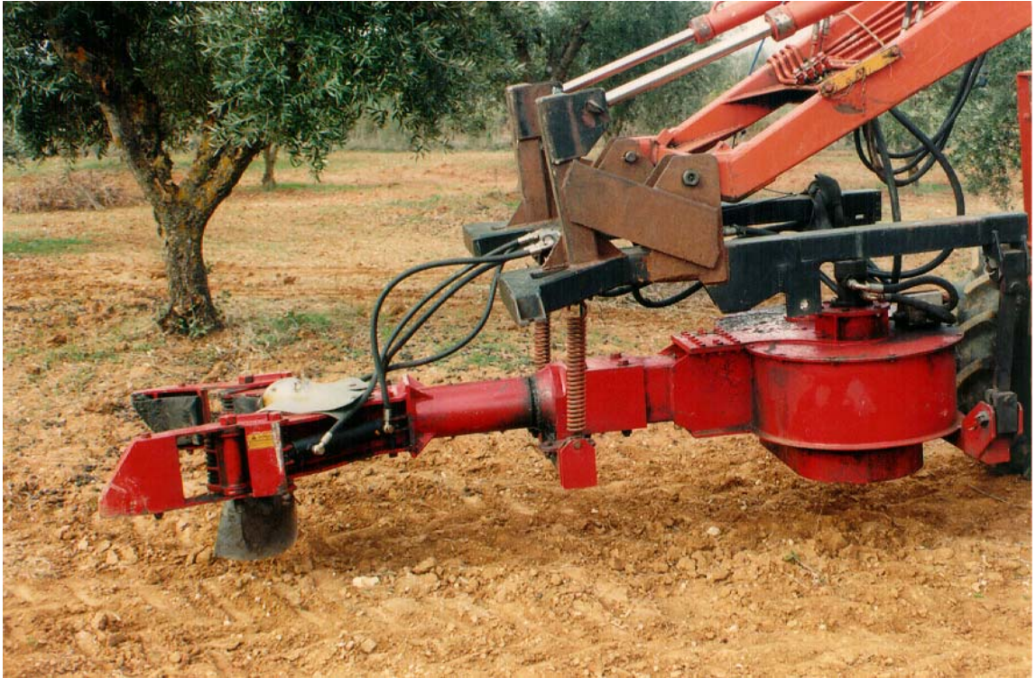
Figura IV-12 - Vibrador utilizado nos ensaios, montado no carregador frontal do tractor.
