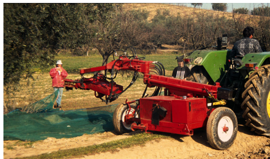
Figura I-18 - Vibrador semi-montado no sistema de engate de três pontos.
