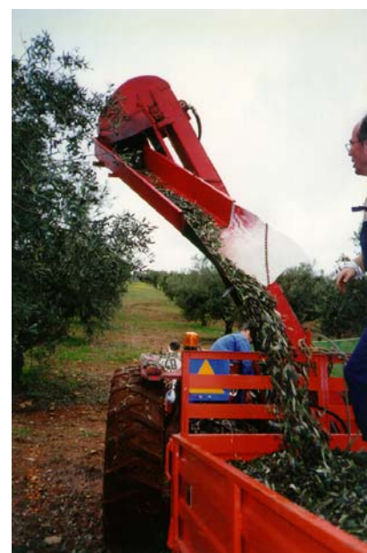
Figura IV-24 - Enrolador de panos descarregando a azeitona para o semi-reboque.
