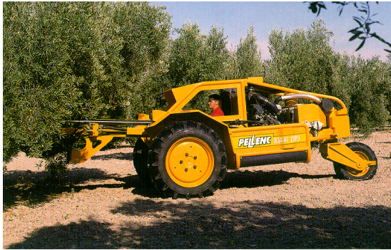
Figura I-19 - Vibrador automotriz. Fonte: catálogo comercial “Pellenc”.
