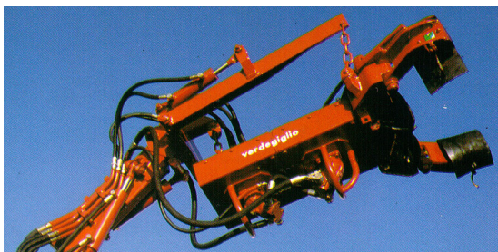
Figura I-22 - Um conjunto de cilindros hidráulicos, permite à cabeça de vibração um número elevado de graus de liberdade.
