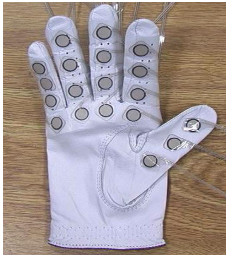
Figura 4 - Luva com sensores de força para os testes realizados por Lu M. et al.
