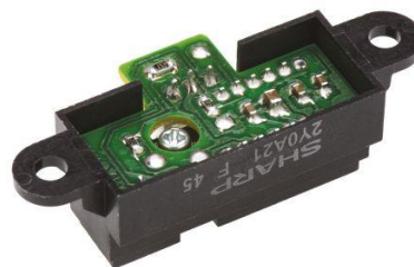
Figura 27 - Sensor de distância GP2Y0A21YK0F.
