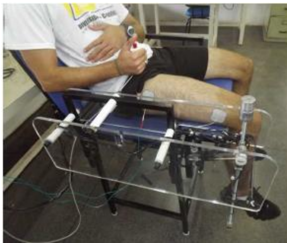
Figura 13 - Cadeira instrumentada utilizada por Mata D. et al.
