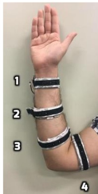
Figura 7 - Sensores FMG utilizados nos testes de Sakr M.
