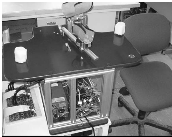
Figura 6 - Aparato para medir a força da mão utilizado por Eklund M. J. et al.
