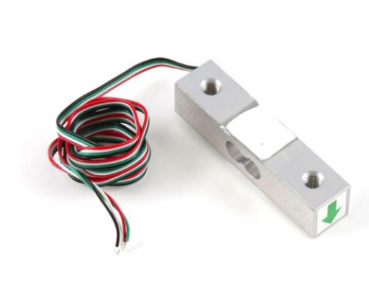
Figura 15 - Célula de carga para medir Hand Force.
