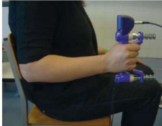
Figura 24 - Dinamômetro computadorizado E - Link para teste hand force.
