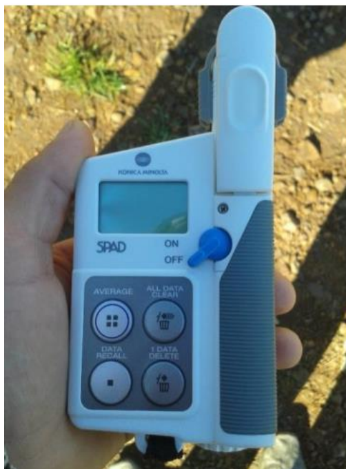
Figura 6 - Clorofilômetro Minolta (modelo SPAD-502), utilizado nas avaliações de teores de clorofila no experimento.
