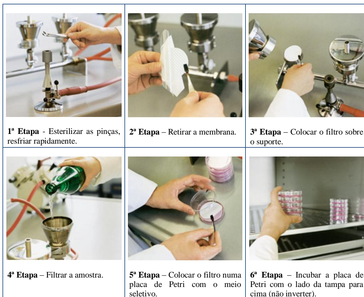
Figura 5.3 - Etapas do processo de Filtração por Membrana para Pseudomonas aeruginosa . (Adaptado de: www.sartorius.com )
