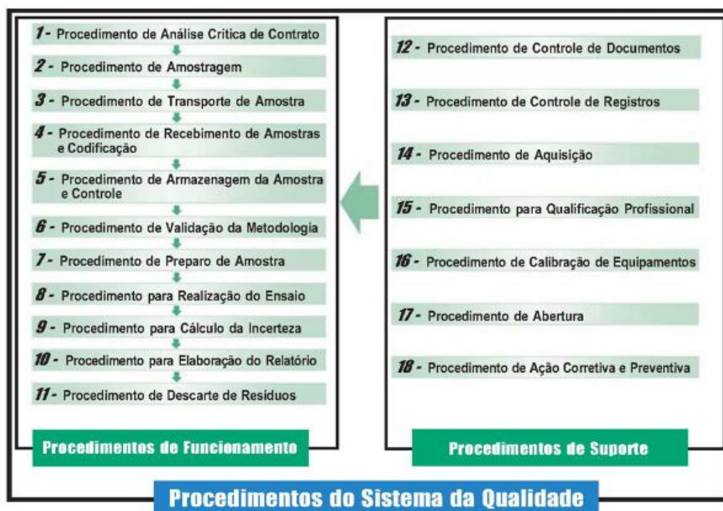
Figura 3.3 - Estrutura básica de procedimentos necessários para a elaboração de um SGQ para Laboratórios. (Adaptado de: Olivares, 2006).
