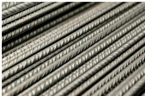
Figura 2 - Varão nervurado. (Ferrolimiana, 2025)
