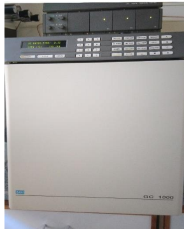
Figura 16 - Cromatógrafo gasoso DANI (modelo GC 1000) onde se levou a cabo a determinação de ácidos gordos
