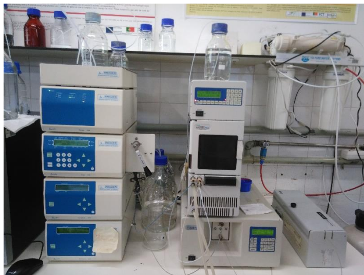
Figura 17 – Equipamento de cromatografia líquida de alta eficiência com um detetor de índice de refração (HPLC-RI) utilizado para determinar a composição de açúcares.
