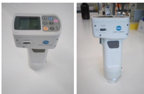
Figura 15 - colorímetro (modelo CR-400, Konica Minolta Sensing Inc., Tóquio, Japão) utilizado para a determinação da cor dos croissants
