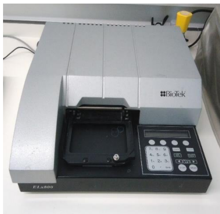
Figura 6 - Leitor de microplacas ELX800 (Bio-Tek Instruments, Inc) onde foi lida a absorvância.
