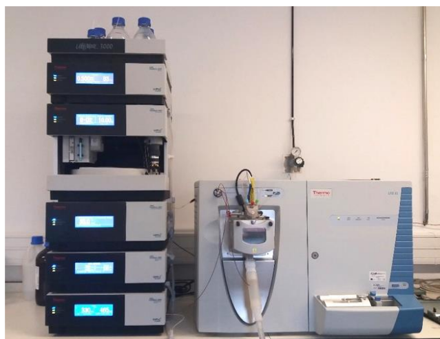
Figura 6. HPLC-DAD-ESI/MS n : sistema disponível nos laboratórios do CIMO.
