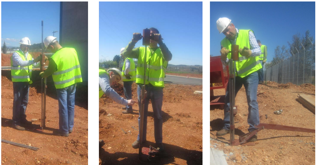
Figura 2 – Ensaio penetrómetro dinâmico ligeiro, DPL
