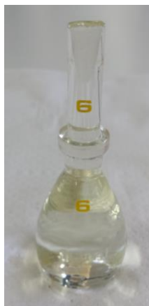
Figura 3.3.2.1 – Picnómetro utilizado na determinação da massa volúmica.
