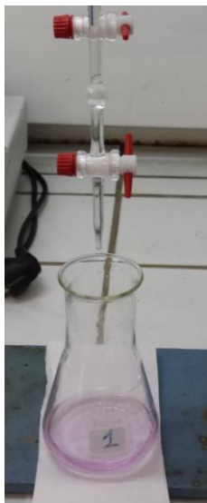
Figura 3.3.5.1 – Titulação realizada na determinação do índice de acidez.
