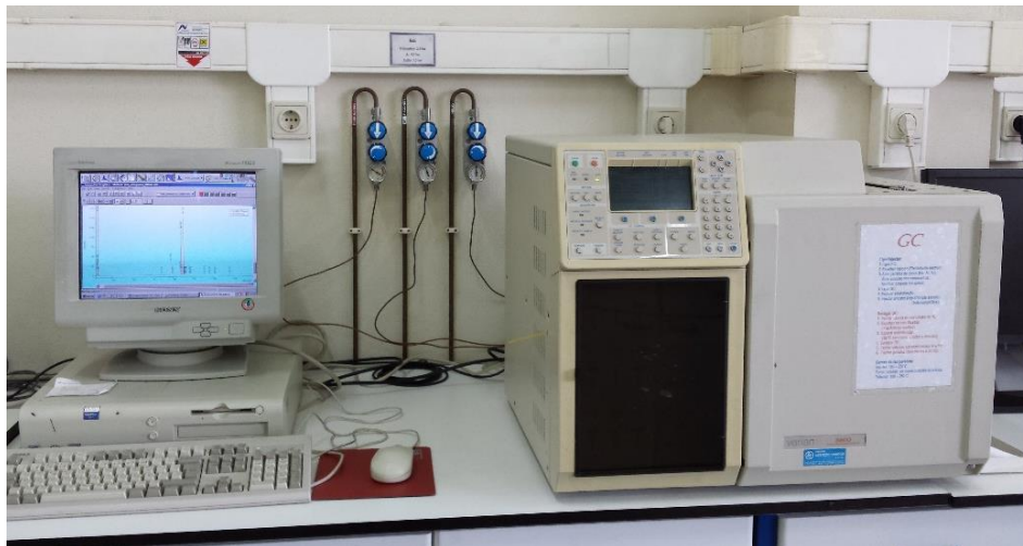
Figura 3.3.1.1 – Cromatógrafo gasoso equipado com detetor FID.
