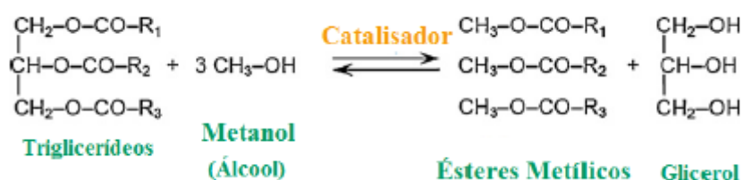
Figura 2.7.3.1 – Reação de transesterificação com metanol e com catalisador básico [20].
