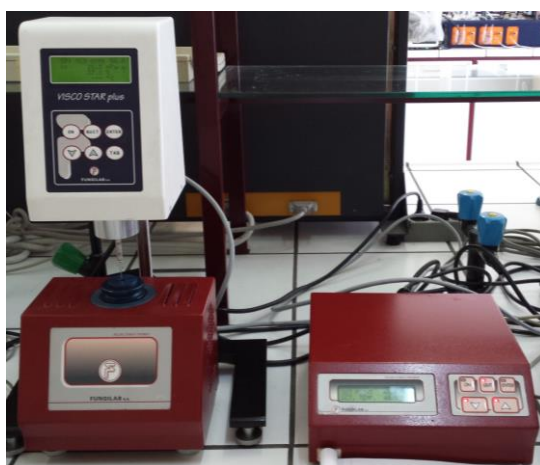
Figura 3.3.3.1 – Viscosímetro utilizado na determinação da viscosidade.
