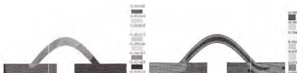
Figura 1. Geometria óptima: (A) distribuição das pressões [ 10^4\text{Pa} ]; (B) distribuição das velocidades [mm/s].
