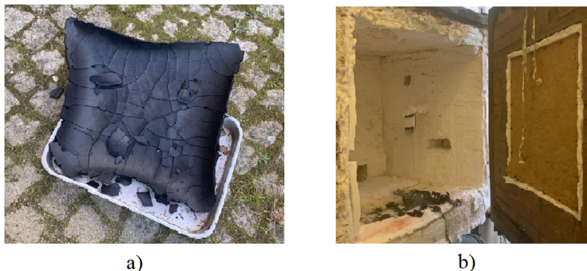
Figura 4.19: a) Carbonização completa da placa de MDF ao fim do ensaio no forno, b) Interior do forno após o ensaio.
