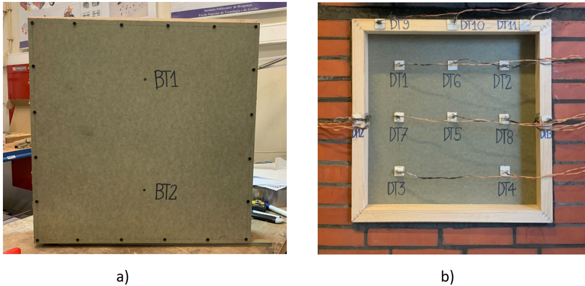
Figura 4.10: a) Lado exposto do modelo de MDF ensaiado, b) Lado não exposto instalado na estrutura do forno do modelo de MDF ensaiado.
