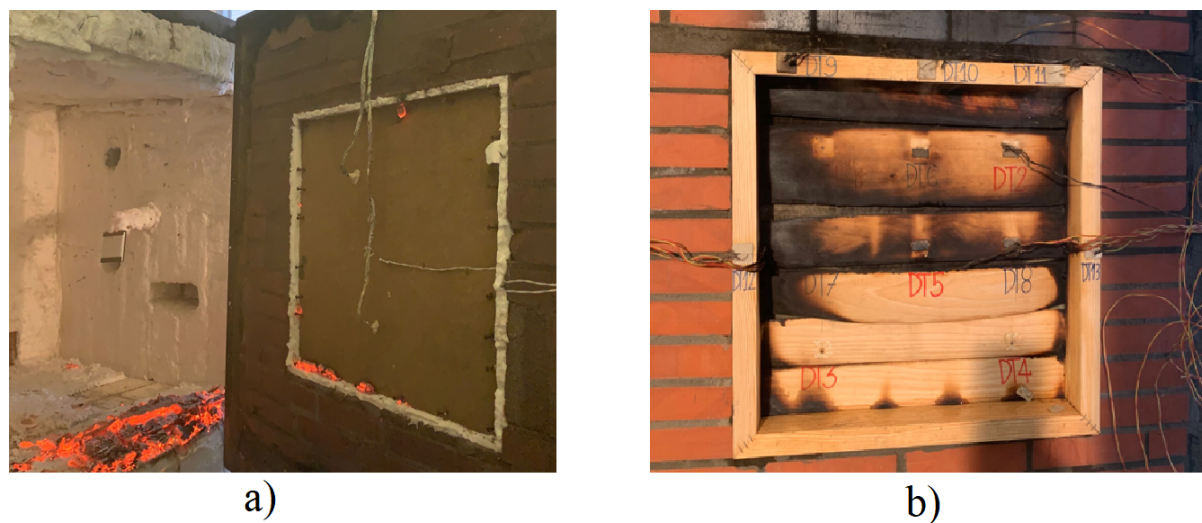
Figura 4.20: a) Interior do forno após o ensaio do modelo de pinho; b) Região não exposta ao fogo da placa de pinho ao final do ensaio no forno.
