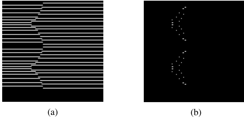
Figura 5.6 Processamento da PCNN a contornos de discontinuidades geométricas horizontais. A imagem original é a (a). O resultado do processamento à imagem (a) é visível na imagem (b) onde estão assinaladas discontinuidades horizontais da imagem original
