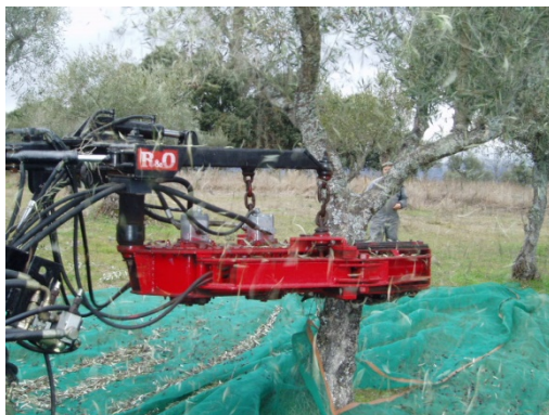
Figura 12.13 - As pernas surgem a 40 cm/50 cm do solo permitindo a vibração ao tronco
