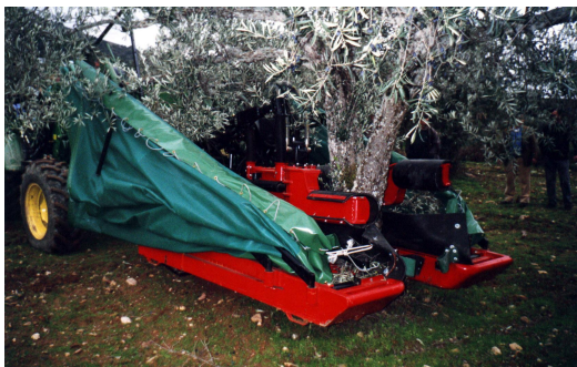
Figura 12.2 - Pinça do vibrador envolvendo o tronco
