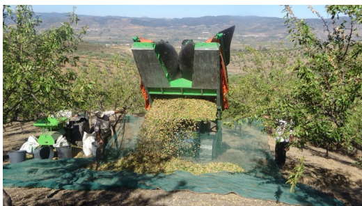
Figura 12.12 - Descarga para lonas da amêndoa colhida com vibrador e avara frutos (Foto R. Tranchete)
