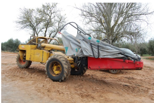
Figura 12.3 - Vibrador de tronco automotriz com apara frutos
