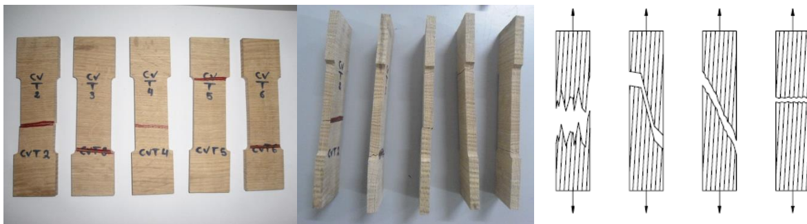
Figura 65- Rotura nos provetes de carvalho na direção perpendicular ao fio: Todos os provetes têm uma rotura por lascamento.
