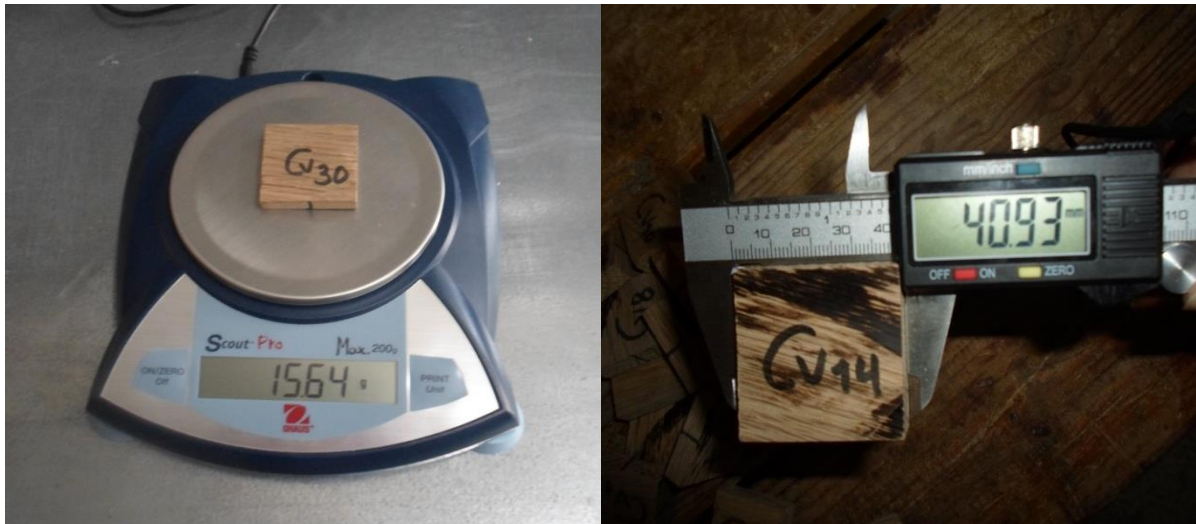
Figura 23- (a) - Balança utilizada; (b) - Paquímetro utilizados.
