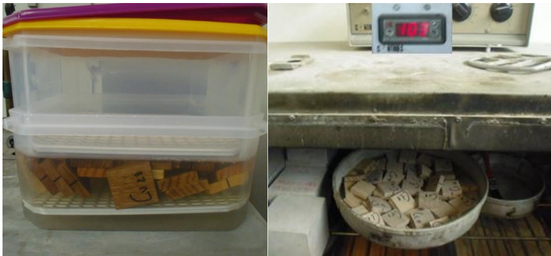
Figura 24- (a) - Provetes saturados em água; (b) - Provetes no forno.
