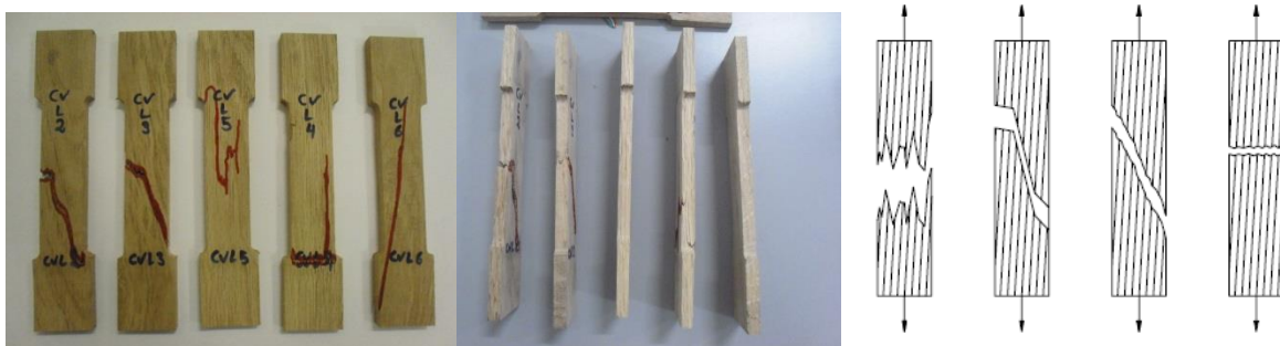
Figura 61- Rotura nos provetes de carvalho na direção longitudinal ao fio: (CVL2 e CVL3) combinação de corte com tração; (CVL4, CVL5) corte.
