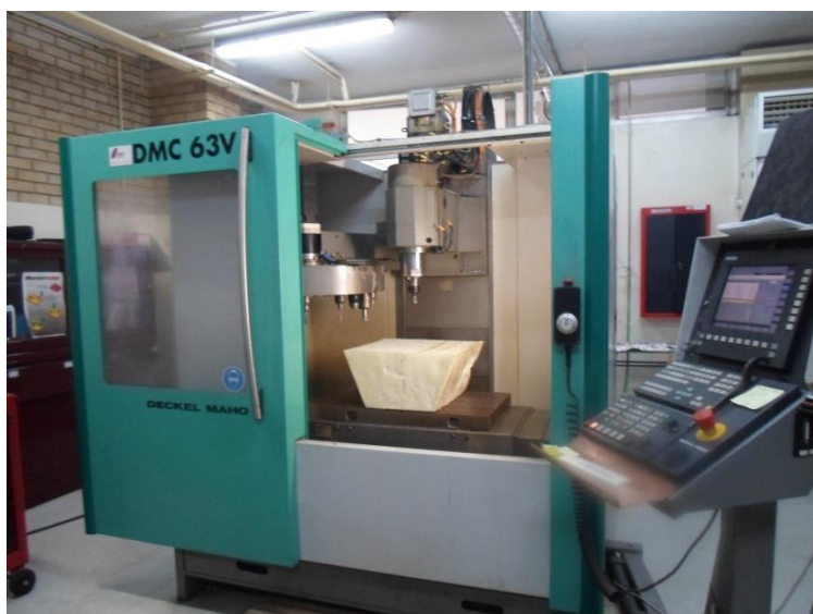
Figura 26 - Máquina utilizada para a obtenção dos provetes (DMC 63V).
