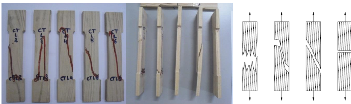
Figura 59 - Rotura nos provetes de castanho na direção longitudinal ao fio: (CTL2 e CTL3) corte; (CTL4, CTL5 e CTL6) combinação de corte com tração.
