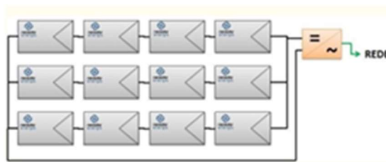
Figura 13 - Configuração de um inversor central com os módulos solares. Fonte: [27].
