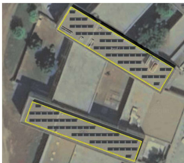
Figura 41 - Esquema de implementação do sistema fotovoltaico ESE. Fonte: [44].
