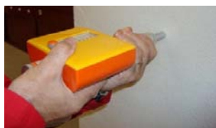
Figura 6: Medições efectuadas com o esclerómetro.
