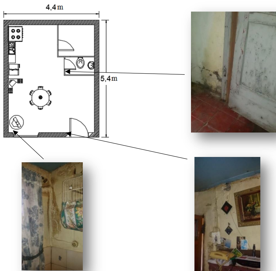
Figura 34 Plantas do edifício (Caso 3) e registo fotográfico das anomalias.
