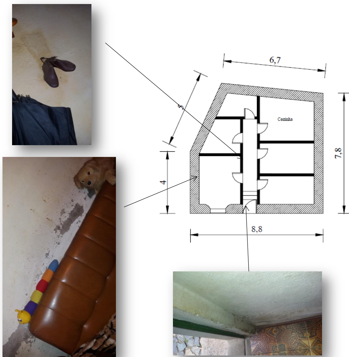
Figura 0-21 Plantas do edifício (Caso 10) e registo fotográfico das anomalias
