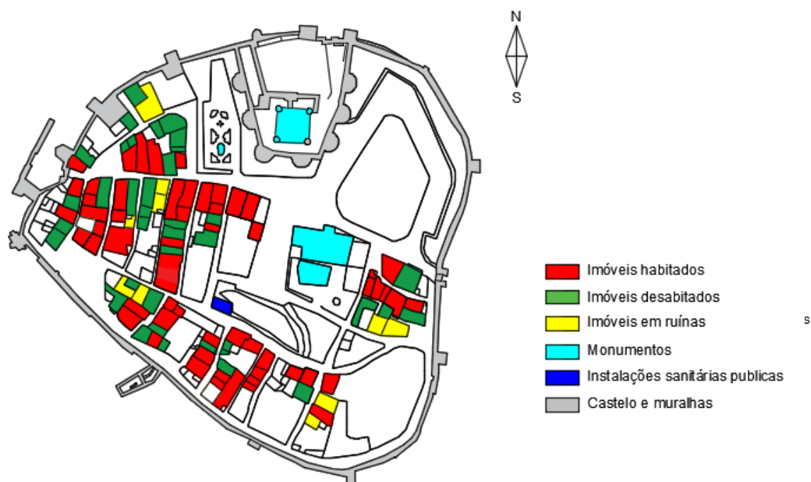
Figura 25 Identificação de imóveis habitados, desabitados e em ruínas.
