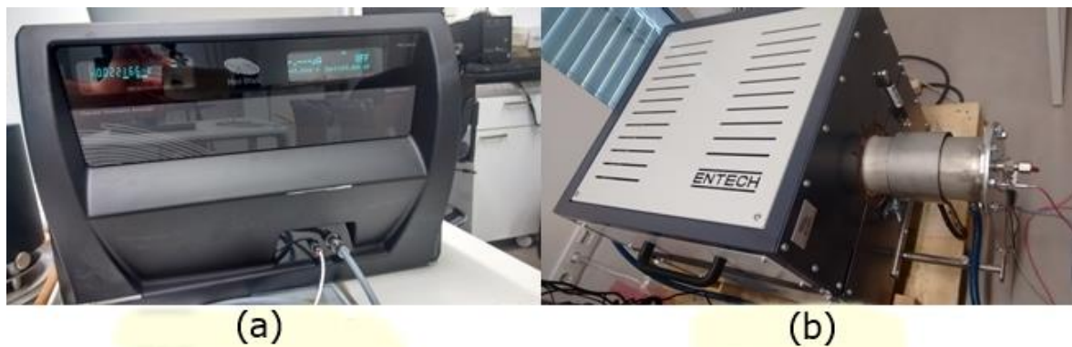
Figura 38. Equipamentos utilizados para medir a condutividade térmica (TPS). a) TPS. b) Forno.
