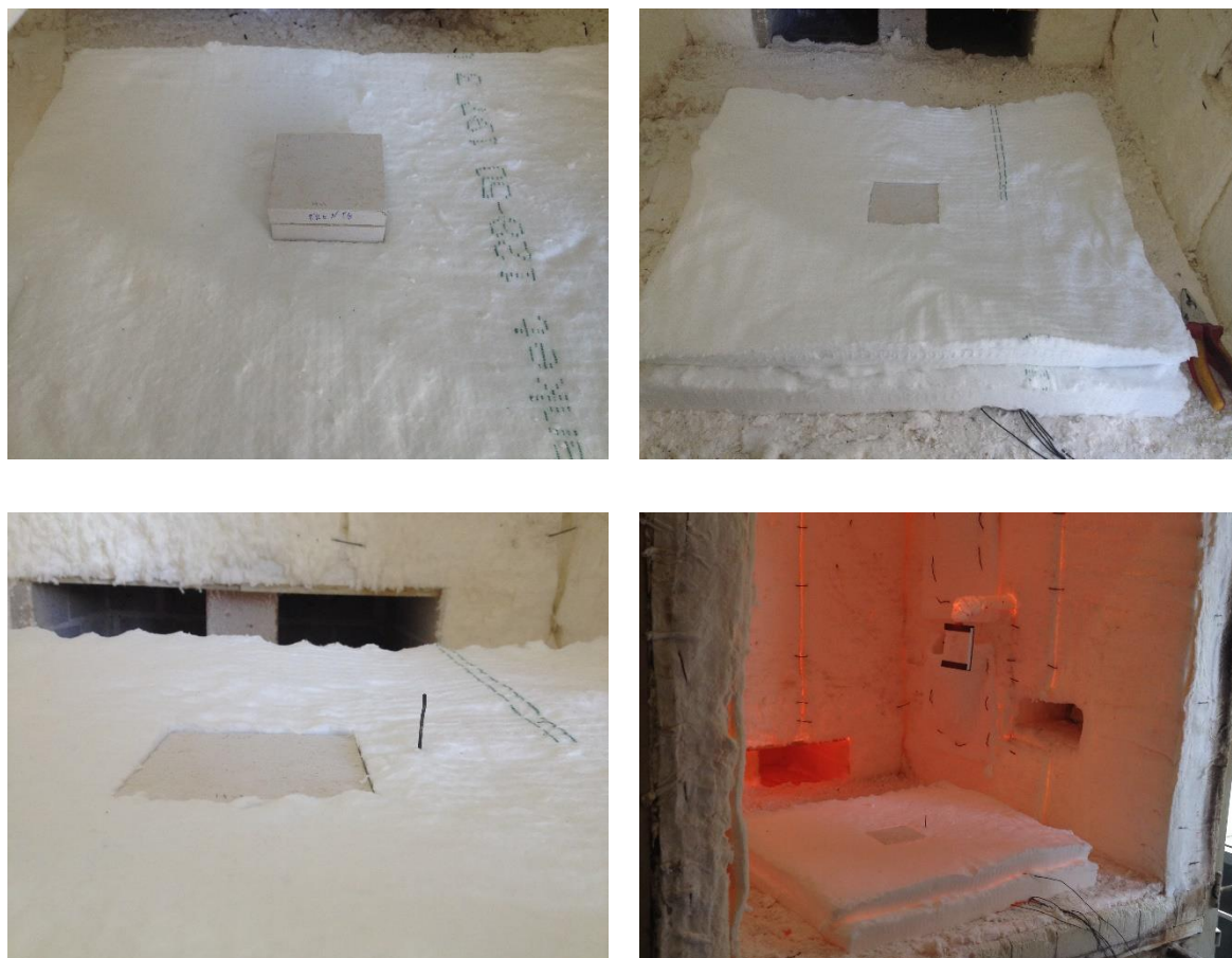
Figura 29. Preparação e ajuste dos termopares nas amostras para execução dos testes no forno.
