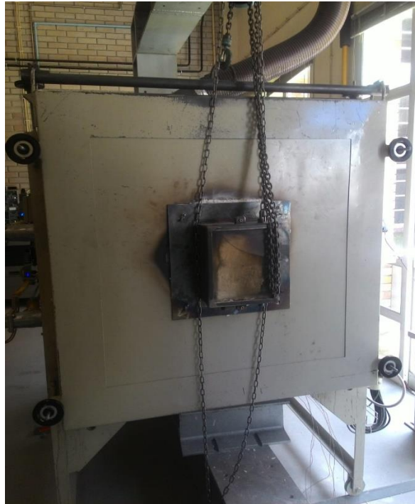
Figura 25. Forno de resistência ao fogo.
