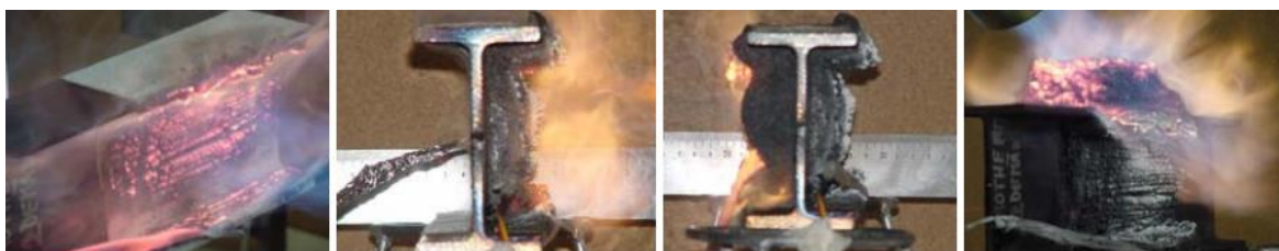
Figura 21. Reação das tintas intumescentes em altas temperaturas,[30].
