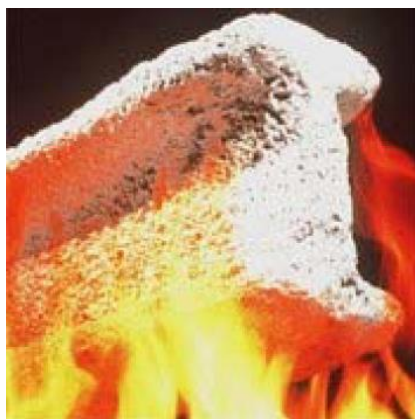
Figura 22. Argamassa projetada sobre uma estrutura de aço, [1].
