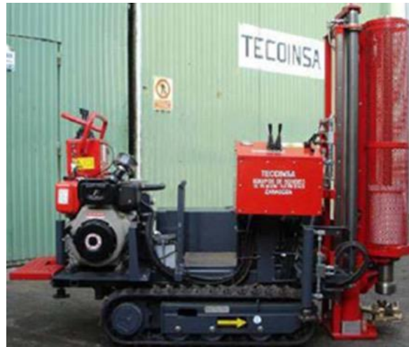
Figura 3 – Ensaio com penetrómetros dinâmicos (DP). Equipamento de ensaio do Instituto Politécnico de Bragança.
