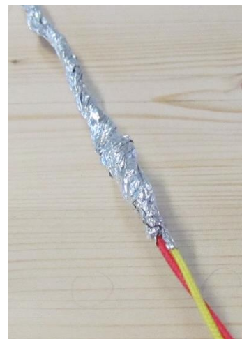
Figura 50 - Preparação da proteção do fio termopar, LTM.
