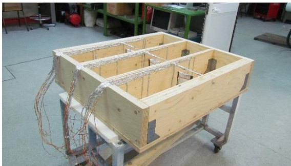
Figura 65 - Finalização da instrumentação da laje no interior das células, LTM.
