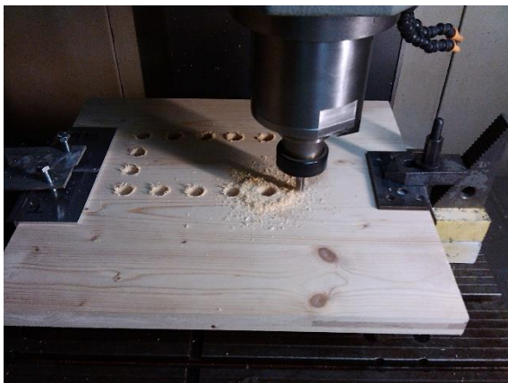
Figura 39 - Maquinação das perfurações de 10 e 20 [mm] na CNC, LTM.
