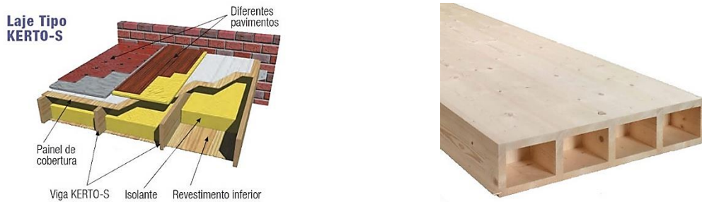
Figura 29 - Modelos de lajes celulares em madeira, (Meireles, 2014).
