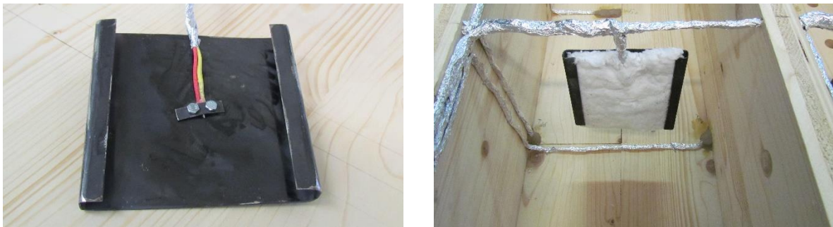
Figura 56 - Processo de construção dos termopares de placa, LTM.
