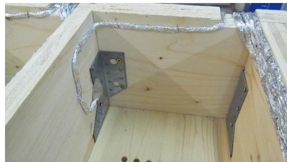
Figura 60 - Colocação dos termopares nos conectores metálicos, LTM.
