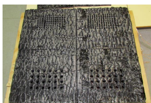
Figura 81 - Laje 2 depois do ensaio experimental, LTM.
