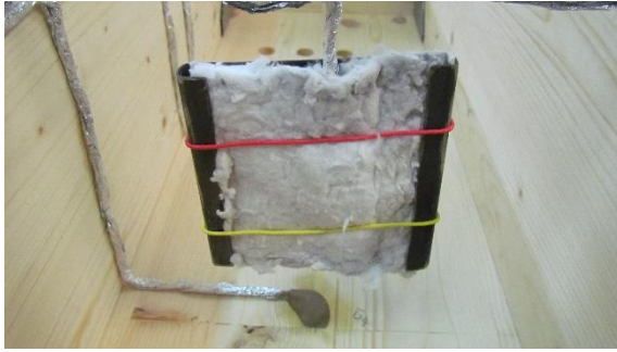
Figura 61 - Colocação dos termopares de placa protegidos com lâ de rocha, LTM.
