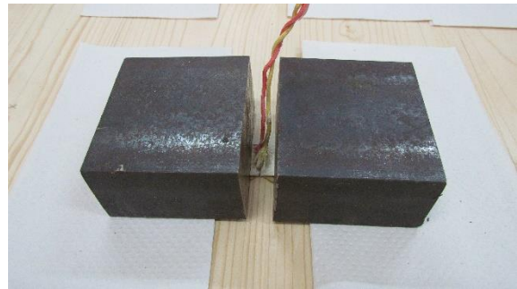
Figura 64 - Colocação dos termopares de disco, com cola térmica, LTM.
