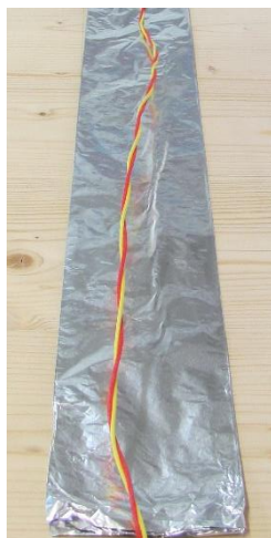
Figura 50 - Preparação da proteção do fio termopar, LTM.
