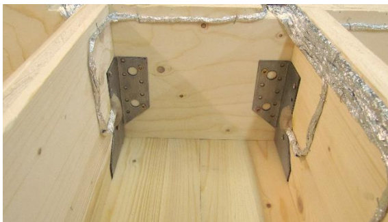
Figura 54 - Termopares colocados nos conectores metálicos, LTM.
