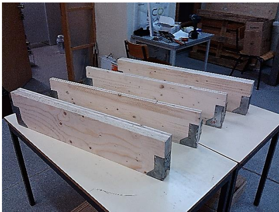
Figura 45 - Vigas com conectores metálicos, LTM.
