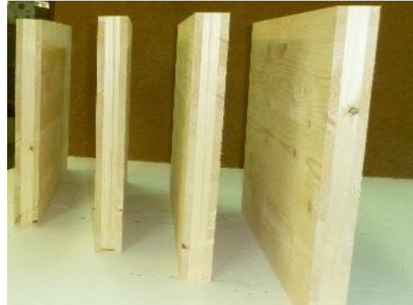
Figura 37 - Placa de teto cortadas em quatro partes iguais, LTM.
