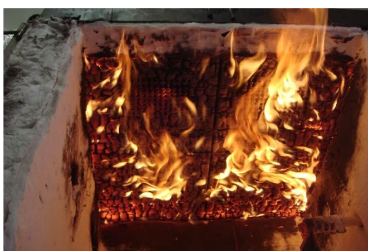
Figura 80 - Instante de abertura da porta do forno depois do ensaio da laje 2, LERM.
