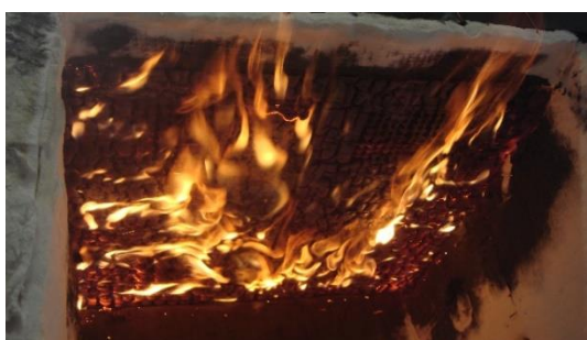
Figura 76 - Instante de abertura da porta do forno depois do ensaio da laje 1, LERM.
