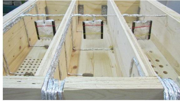
Figura 62 - Termopares de placa no centróide das células, LTM.
