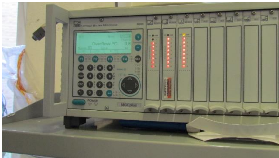
Figura 67 - Equipamento para aquisição de dados, MGCplus, LERM.
