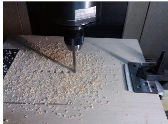
Figura 38 - Colocação de 1/4 de placa de teto na máquina CNC e início da maquinação, LTM.
