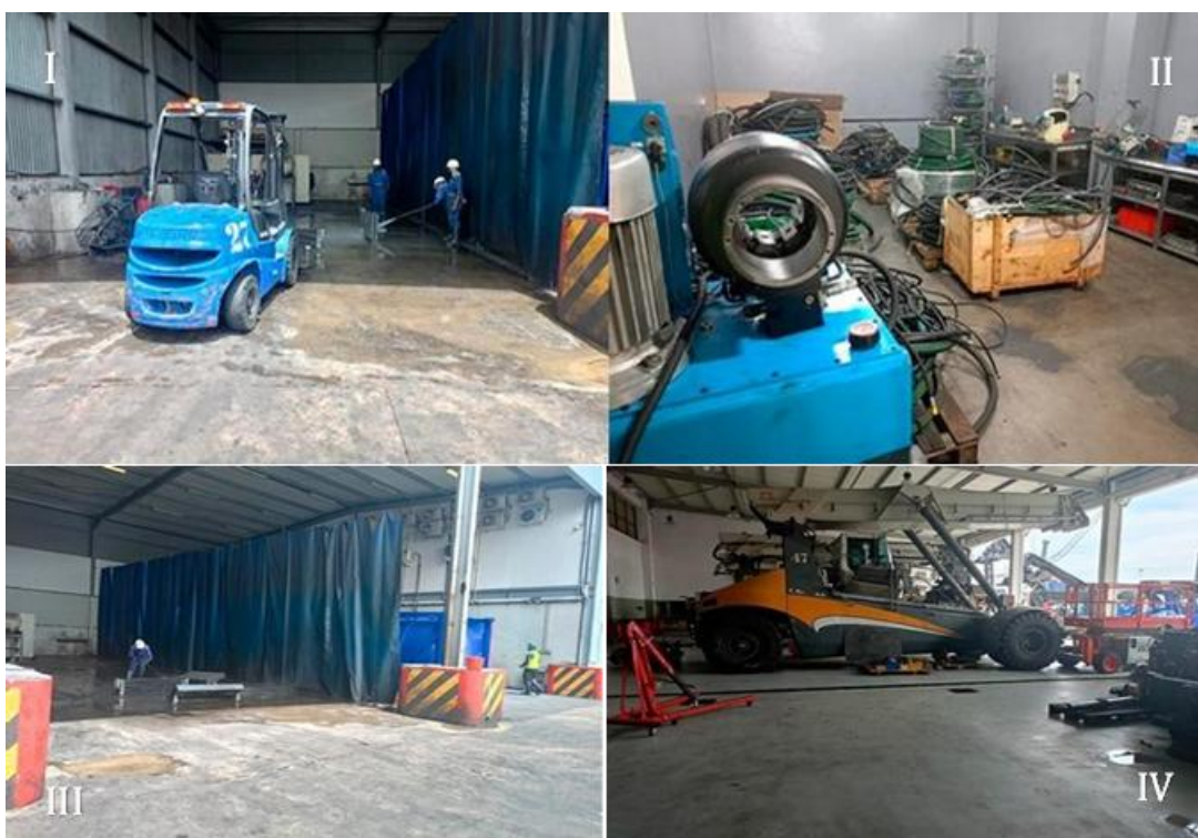
Figura 5: Áreas operacionais da oficina da SOGESTER: (I) área de lavagem de equipamentos, com empilhador em operação; (II) área de armazenamento de motores e componentes hidráulicos; (III) área de pintura de materiais; e (IV) área de manutenção de máquinas pesadas, com equipamento portuário em reparação.
