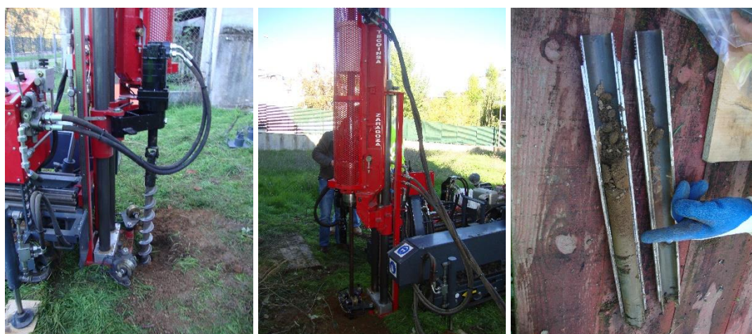
Figura 2.3 –Equipamento do ensaio SPT utilizado (trado helicoidal, dispositivo automático de queda e amostrador normalizado de Terzaghi).
