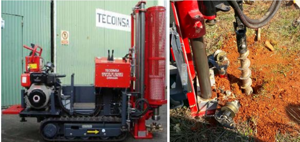
Figura 3.3 – Penetrómetro dinâmico portátil do Laboratório de Geotecnia do Instituto Politécnico de Bragança.
