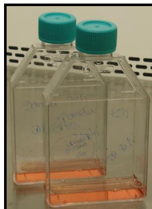
Figura 11: Frascos de cultura celular contendo cada um 2 mL de SFB, 1 mL de fitohemaglutinina PHA-M, 17 mL de meio RPMI 1640 e 500 \mu L da solução celular.
