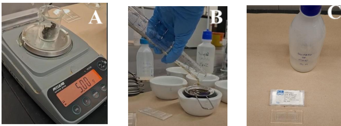
Figura 6. McMaster. Etapas do preparo da amostra fecal para contagem de ovos por grama (OPG) com o método MacMaster, utilizando a técnica de flotação com solução saturada de sulfato de zinco. A amostra (5 g) foi pesada em balança analítica (A), macerada e homogeneizada com a solução (B), sendo posteriormente filtrada para eliminar partículas grosseiras e facilitar a leitura em câmara de contagem (C).
