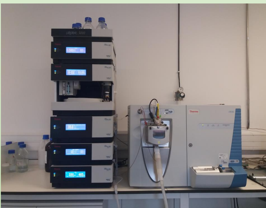
Fig. 1 HPLC-DAD-ESI/MS n usado na identificação e quantificação de compostos fenólicos
