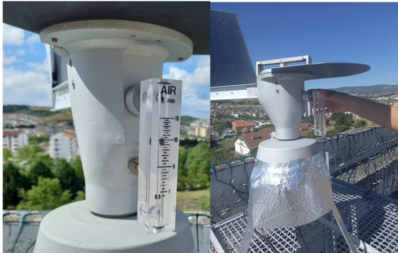
Figura 8 - Verificação do caudal de entrada por meio de fluxímetro. Fonte: Autoria própria (2022).
