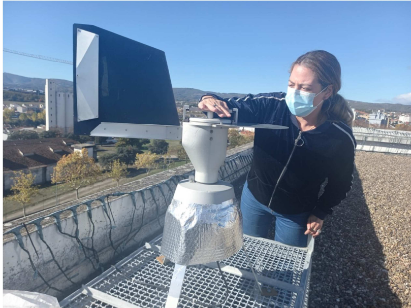
Figura 7 - Barra de bloqueio sendo pressionada para troca do tambor. Fonte: Autoria própria (2022).
