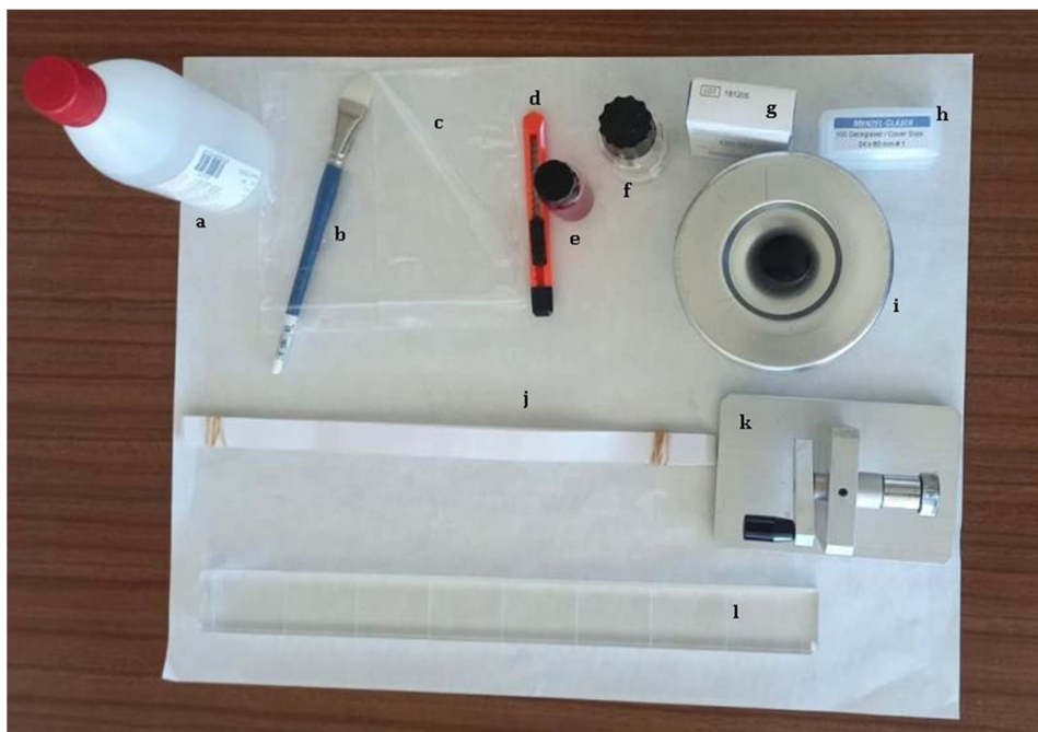
Figura 9 - Materiais utilizados para a preparação das amostras. (a) álcool etílico, (b) pincel, (c) conta gotas, (d) estilete, (e) solução de gliceroelatina com fucsina básica, (f) solução de silicone, (g) lamina, (h) lamela, (i) porta-tambor, (j) fita Melinex, (k) suporte, (l) regua de acrílico transparente específica. Fonte: Autoria própria (2022).
