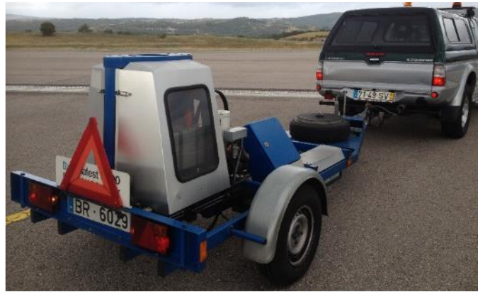
Figura 3.2 - Exemplo de deflectômetro de impacto, Dynatest FWD.
