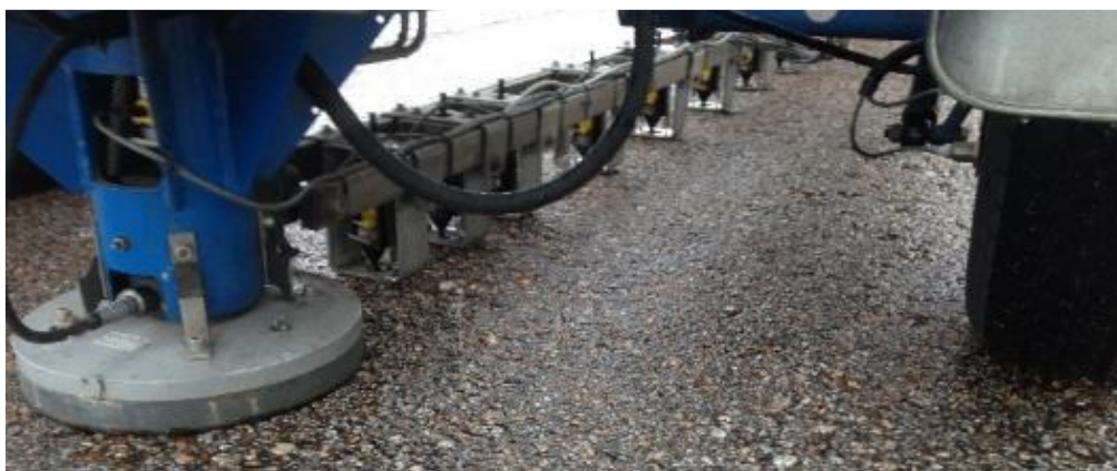
Figura 3.4 - Geofones em funcionamento pelo FWD.
