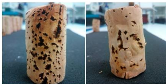
Figura 35: Imagens de rolhas de cortiça após a extração com CO 2 supercrítico (experiência 2: 40 °C – 160 bar – 2 h).
