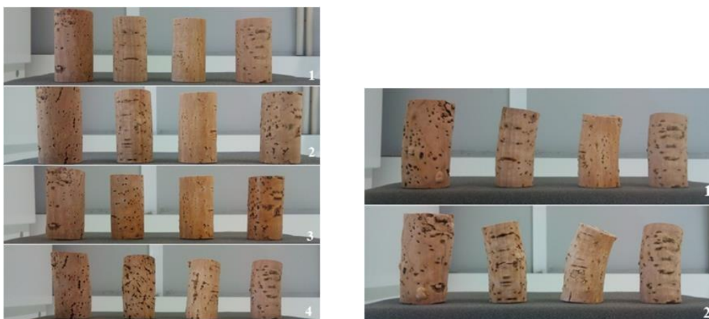
Figura 36: Registro fotográfico das rolhas de cortiça usadas na experiência 15. As rolhas foram inicialmente submetidas a um pré-tratamento com CO 2 gasoso (esquerda) e depois à extração com CO 2 supercrítico (direita). Figura à esquerda: 1: Rolhas iniciais; 2: Rolhas após a primeira fase de pré-tratamento com CO 2 gasoso; 3: Rolhas após a imersão em água fervente; 4: Rolhas após a segunda fase de pré-tratamento com CO 2 gasoso (90 °C – 26 bar – 3 h). Figura à direita: 1: Antes da extração; 2: Depois da extração com CO 2 supercrítico (60 °C – 160 bar – 10 h).
