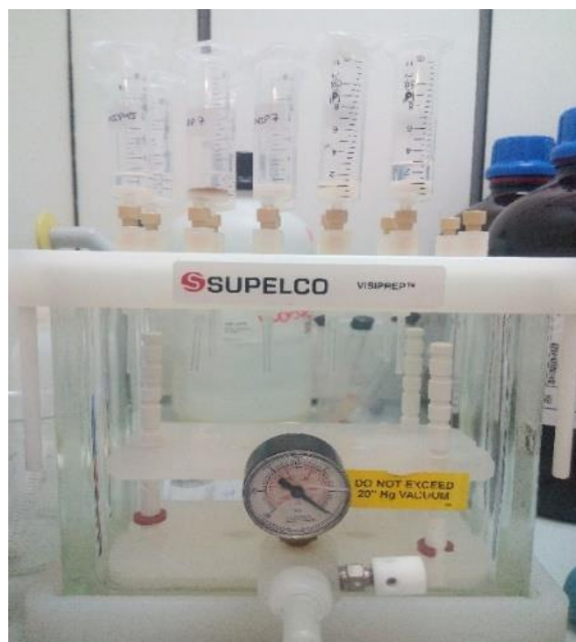
Figura 48: Sistema de extração em fase sólida (SPE) usado neste trabalho.
