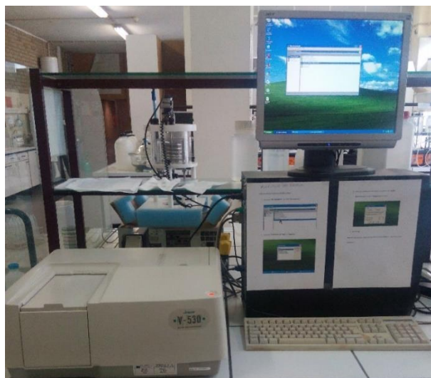
Figura 49: Equipamento de espectrometria UV-vis utilizado neste trabalho.
