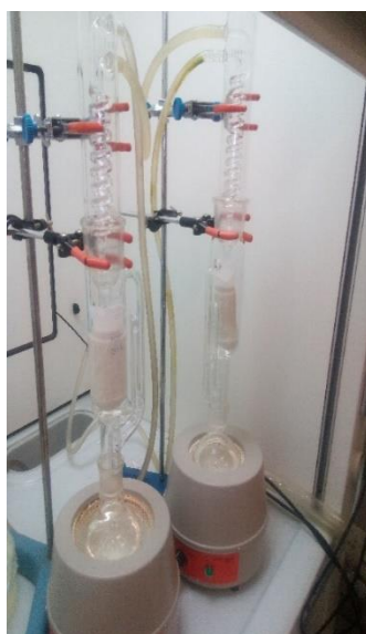
Figura 46: Método soxhlet considerado na purificação de MIPs e esquematização do aparelho (instalação experimental utilizada). Esquema adaptado de (Extração de lipídios em alimentos, 2010).
