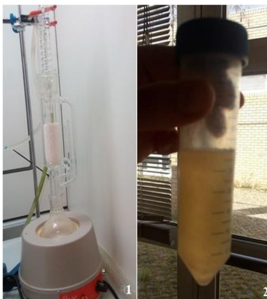
Figura 52: Extração de granulado de cortiça através da técnica soxhlet. 1- Equipamento já com o cartucho colocado; 2- Extrato obtido onde se pode observar a formação de um precipitado.
