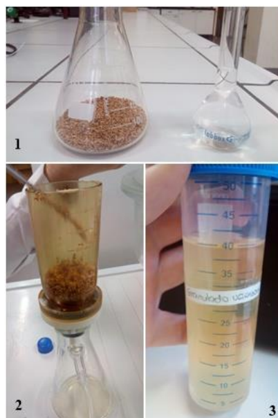
Figura 54: Extração com ultrassons do granulado de cortiça. 1- Amostra e solvente preparado; 2- Solução submetida a filtração; 3-Extrato final.
