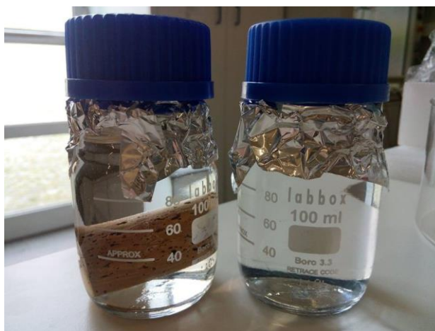
Figura 22: Registo fotográfico de uma experiência realizada para o estudo da difusão do TCA em rolhas de cortiça. A imersão de uma rolha numa solução contendo TCA foi acompanhada pela experiência análoga em “ branco ”.
