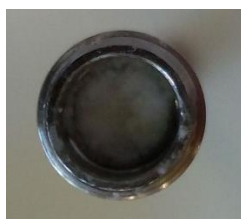
Figura 62: Coluna com a quantidade de MIP_7 já empacotado estando uma das extremidades ainda aberta.
