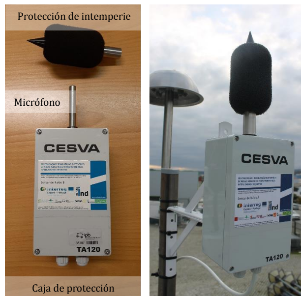
Figura 13 – Sistema de monitoreo de ruido continuo. (izquierda) sensor de ruido con sus componentes; (derecha) sistema instalado en el campo.
