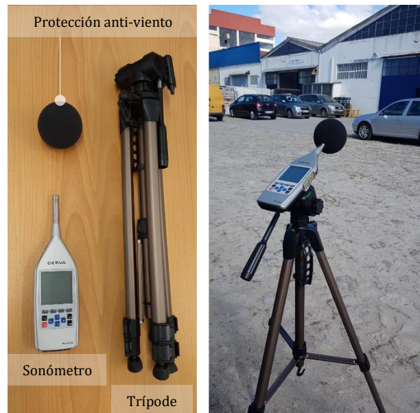
Figura 12 – Equipo utilizado para las campañas de medición del ruido. (izquierda) sonómetro junto al conjunto de accesorios utilizados; (derecha) ilustración de la aplicación del sistema de medición
