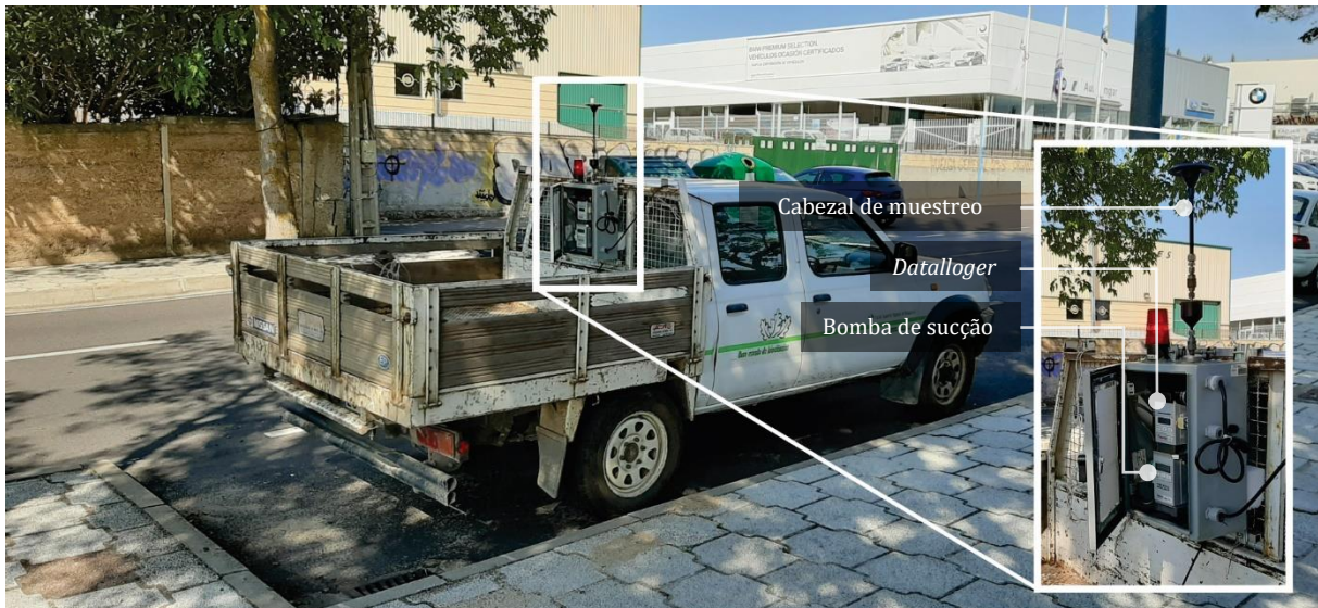
Figura 9 – Método utilizado durante las campañas de medición de partículas, que muestra el monitor de partículas THERMO ADR-1200S (ampliado) montado en una camioneta
