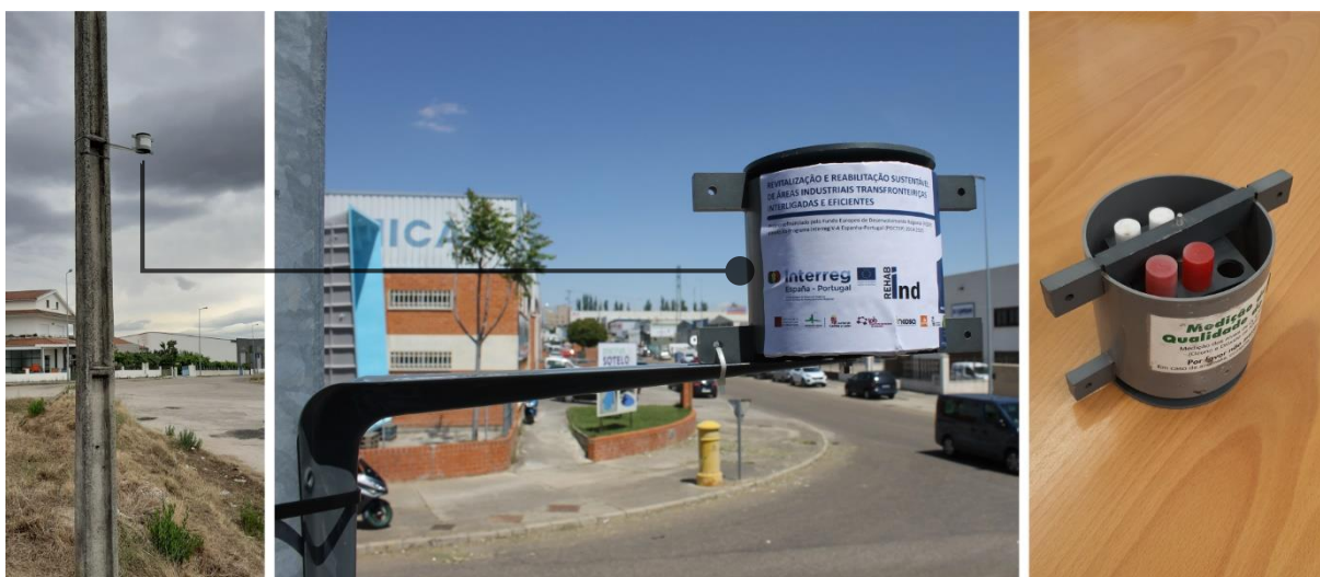
Figura 11 – Método de muestreo pasivo; (izquierda) refugio fijado en uno de los lugares de medición; (centro) vista del refugio en detalle; (derecha) refugio sin la cubierta superior que muestra cómo se colocan los tubos pasivos en el interior
