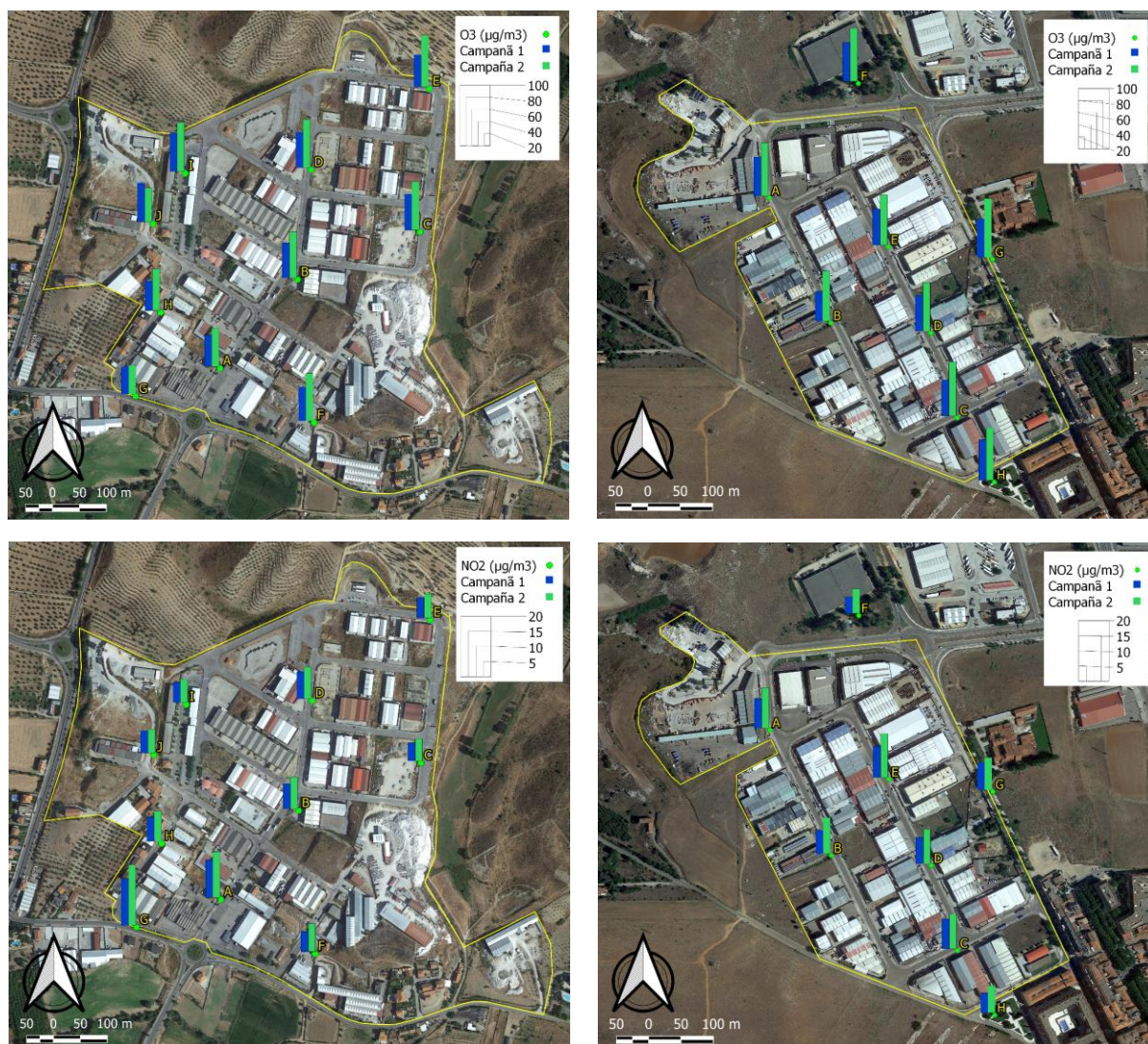
Figura 20 – Muestreo pasivo de ozono y dióxido de nitrógeno. Los mapas de la izquierda corresponden a los muestreos realizados en el polígono industrial de Mirandela y los mapas de la derecha corresponden a los muestreos realizados en el polígono industrial de Hiniesta en Zamora. Los mapas superiores muestran las concentraciones de ozono, mientras que los mapas inferiores muestran los resultados del dióxido de nitrógeno. La primera campaña está marcada en azul y la segunda campaña en verde.
