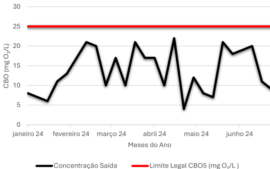
Figura 14: Concentração da CBO 5 à saída da ETAR e o valor limite estabelecido na licença
