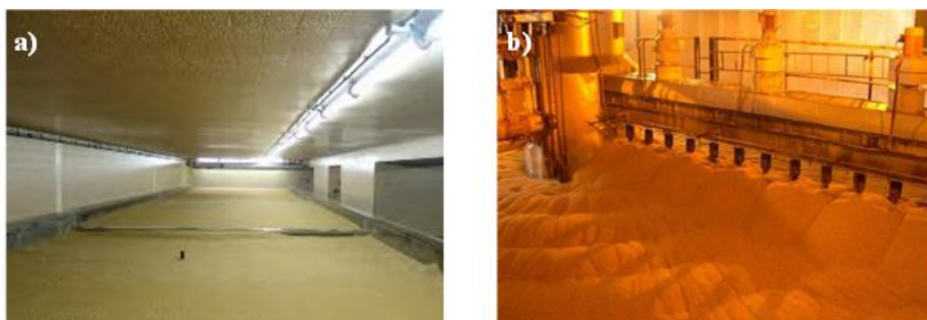
Figura 11. Equipamentos utilizados para a realização da etapa de germinação: a) caixas e b) tanques (Adaptado de Maltibérica, 2009 e GBS, 2015)
