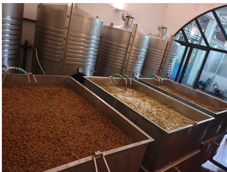
Figura 11 – Disposição dos contentores utilizados para maceração na Quinta da Lixa.
