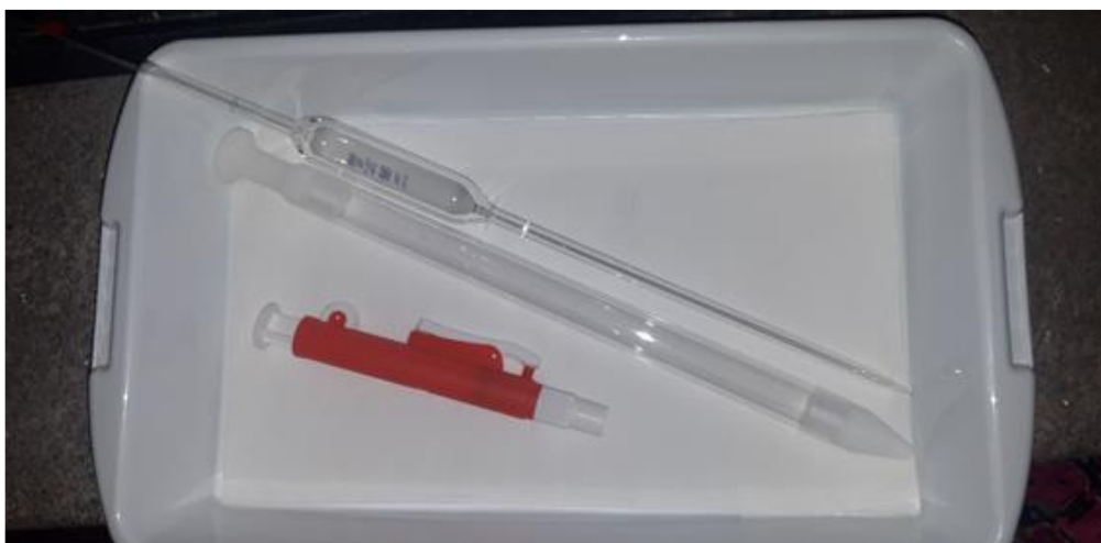
Figura 36 - Instrumentos utilizados para a amostragem, pipeta volumétrica, pipetadora e argau.
