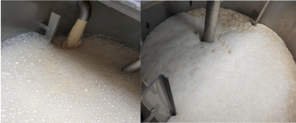
Figura 15- Preparação dos nutrientes e leveduras para inoculação de cuba em tratamento.
