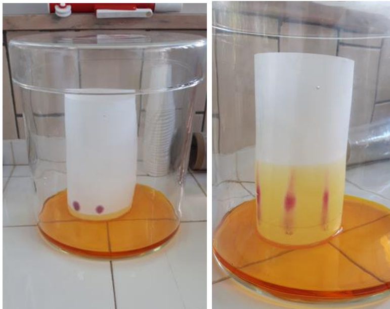
Figura 31 - Representação da migração do ácido málico a ácido láctico por cromatografia em papel
