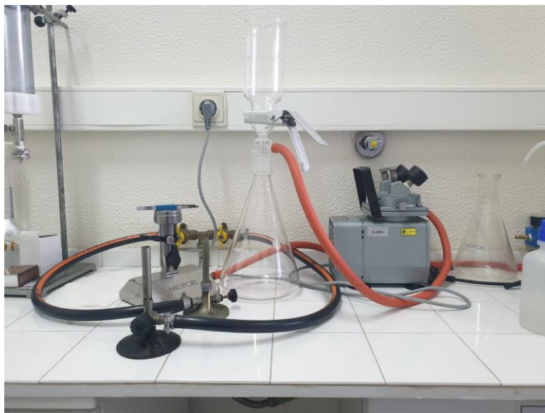
Figura 33 – Sistema de filtração por vácuo para realização de controlo microbiológico.
