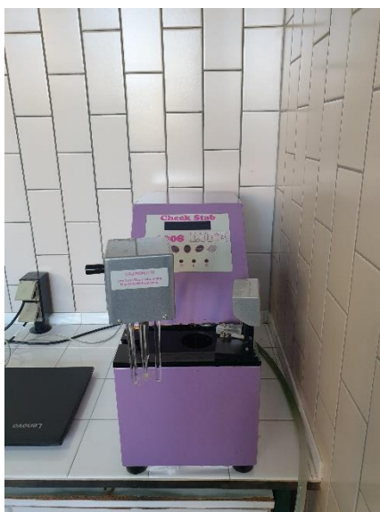
Figura 25 – Equipamento Check Stab – Estabilização tartárica.
