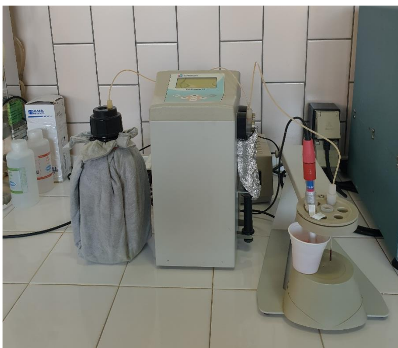
Figura 27 – Equipamento pH Burette 24 – Determinação de sulfurosos
