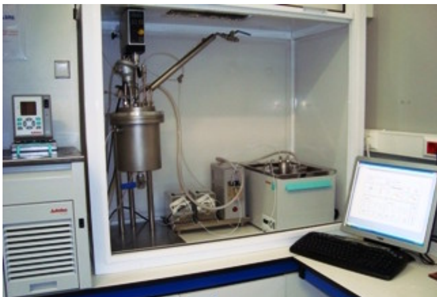
Figura 2: Registo fotográfico da instalação experimental usada nas polimerizações lineares ou não lineares, convencionais ou controladas do sistema S/DVB com operação em reactor fechado ou semi-fechado.
