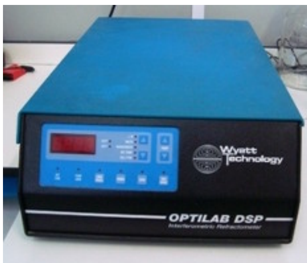
Figura 5: Registo fotográfico de um refractómetro OPTILAB DSP 633 nm interferometric da Wyatt Technology
