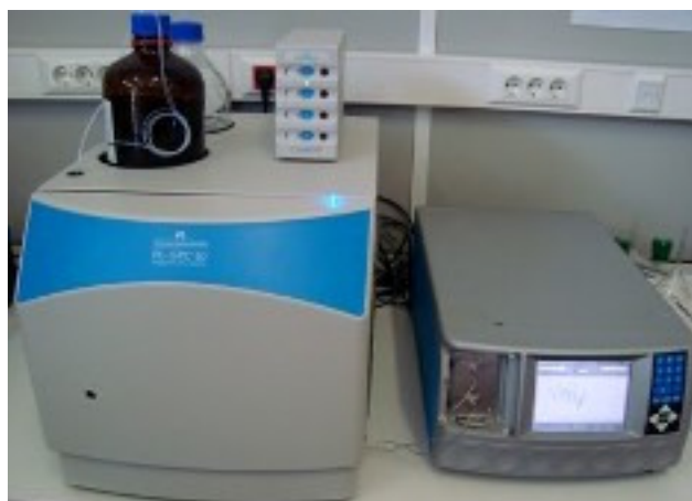
Figura 3: Registo fotográfico de Polymer Laboratories PL-GPC-50 contendo o sistema SEC com refractómetro diferencial (RI) na gama de 950 \pm 30 nm ligado a um detector de dispersão de luz multi-ângulo (MALLS) Wyatt Technology DAWN8 + HELEOS 658 nm
