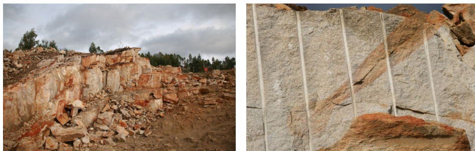
Figura 14: A intensa fracturação e a variabilidade cromática diminuem o rendimento das pedreiras no granito de Mondim de Basto.
