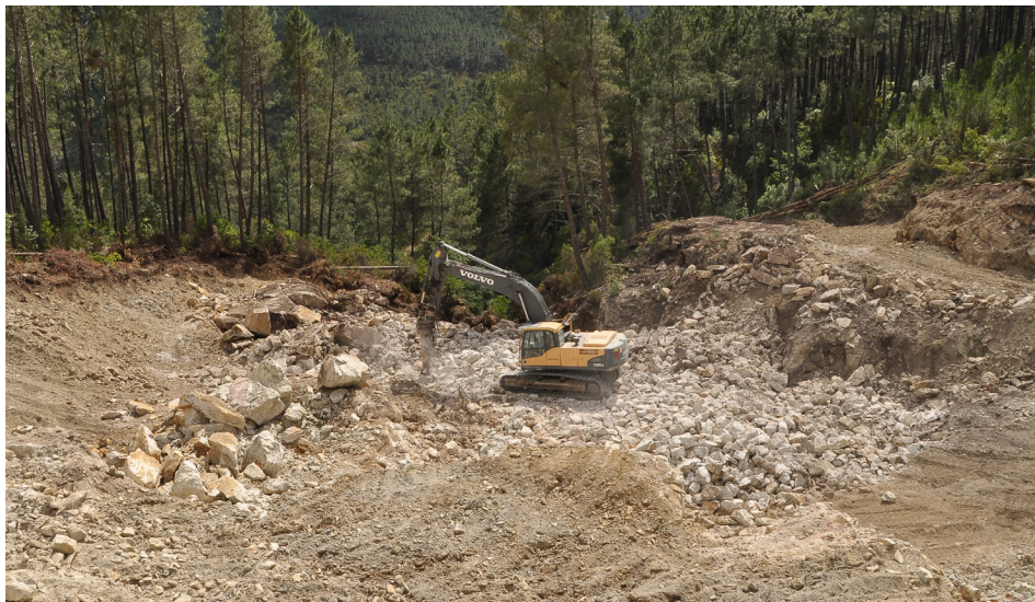
Figura 15: Exploração pela Felmica, de pegmatito com petalite ( \text{LiAlSi}_2\text{O}_{10} ) para a cerâmica, em Lousas, Boticas (2017).
