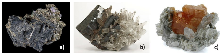
Figura 1: Diferentes minerais de volfrâmio: a – ferberite (Minas da Panasqueira, 18x13 cm); b – hubnerite (Black Pine Mine, 6,0 x 3,6 x 3,5 cm); c – scheelite (Mt Xuebaoding, 6,2 x 4,4 x 3,3 cm). (Fonte: Wikipedia).
