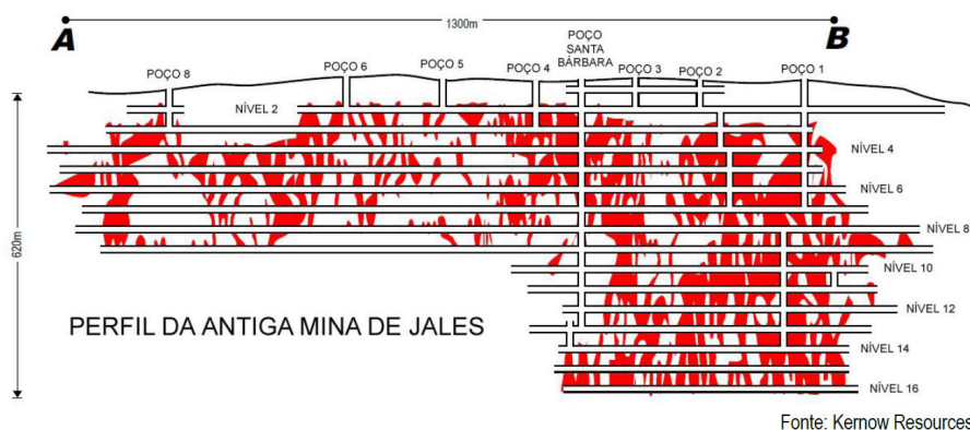
Figura 4: Perfil da Mina de Jales no final das operações.
