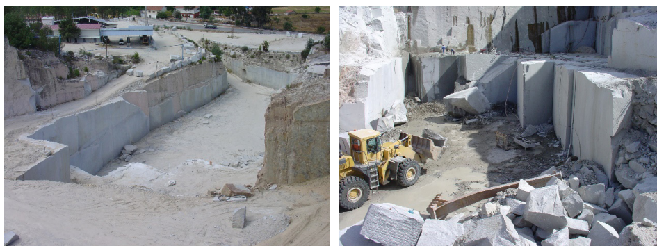
Figura 8: Nas pedreiras do granito de Pedras Salgadas é possível observar grandes zonas do maciço pouco fraturadas, tornando possível obter blocos de grandes dimensões.
