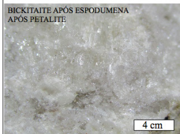
Estampa 5: Evidências mesoscópicas principais de estádios precoces de alteração deutérica ou metassomatismo, responsáveis pelo decaimento dos conteúdos de \text{Li}_2\text{O} a partir de associações com petalite de fracciação primordial.
