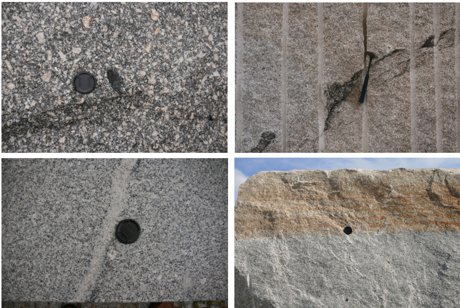
Figura 3: Exemplos de heterogeneidades que diminuem o valor comercial do granito (em cima: concentrações biotíticas; em baixo à esquerda: filão aplitico; em baixo à esquerda: variação de cor).
