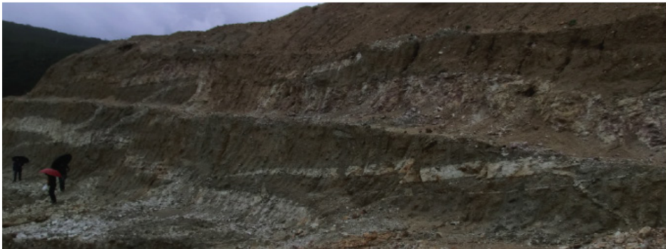
Figura 14: Mina de Alvarrões; Cabanas, Região da Guarda; Exploração de mistura feldspática alitinada, em aplito–pegmatitos LCT, lepidolíticos. Representa o ciclo extrativo cerâmico atual.
