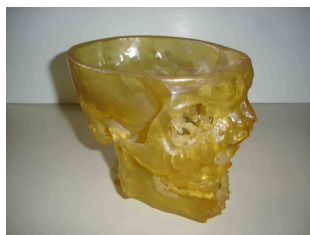
Figura 1- Protótipo de um crânio em estereolitografia para efeitos de visualização e treino cirúrgico.
