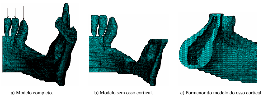
Fig. 2 – Modelo discreto da mandíbula com implantes e dentes.
