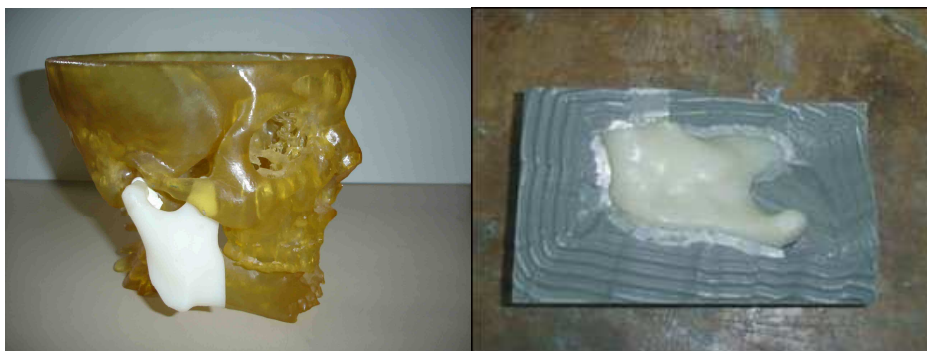
Figura 2 - Utilização de moldes em silicone para conversão de modelos: a) molde com o modelo em estereolitografia de uma região de um crânio; b) instrumentação do molde para optimização do processo de fabrico tendente à redução do tempo de arrefecimento das ceras neles injectadas.
