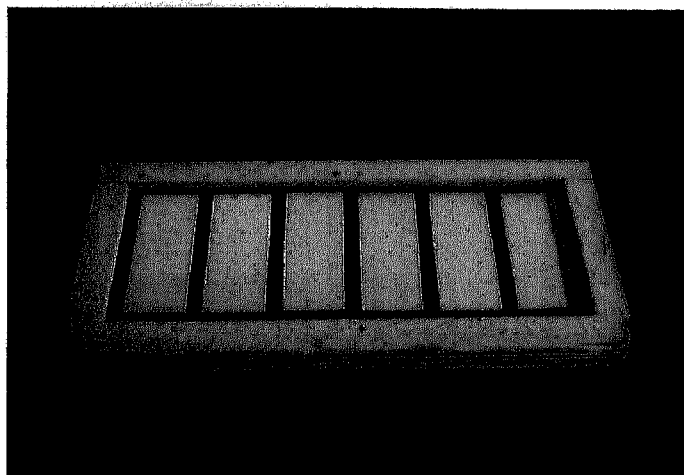
Figura 30 Modelo em madeira foi cheio com silicone e deu origem ao Molde (parte I) destinado ao fabrico de provetes em chamote.
