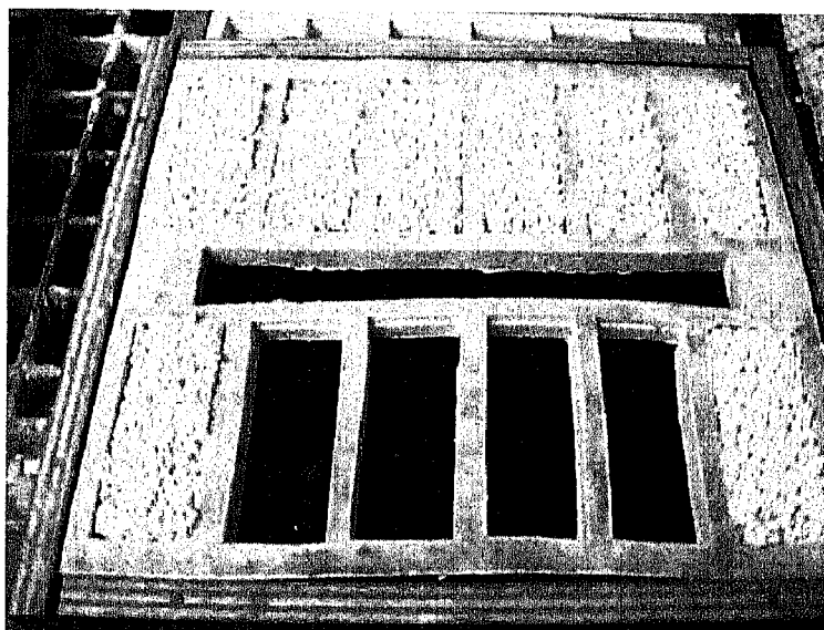
Figura 34 Molde (parte II) destinado ao fabrico de provetes cerâmicos compósitos. Estão colocados provetes no molde.
