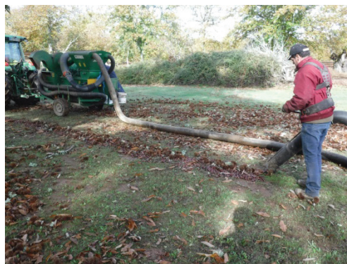
Figuras 12.4 e/y 12.5 – Colhedor por vácuo rebocado em trabalho. Recogedor mediante aspiración remolcado por tractor.
