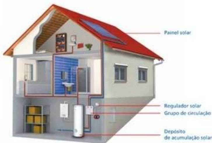
Figura 15 - Esquema do princípio de funcionamento de um sistema solar térmico [18]
