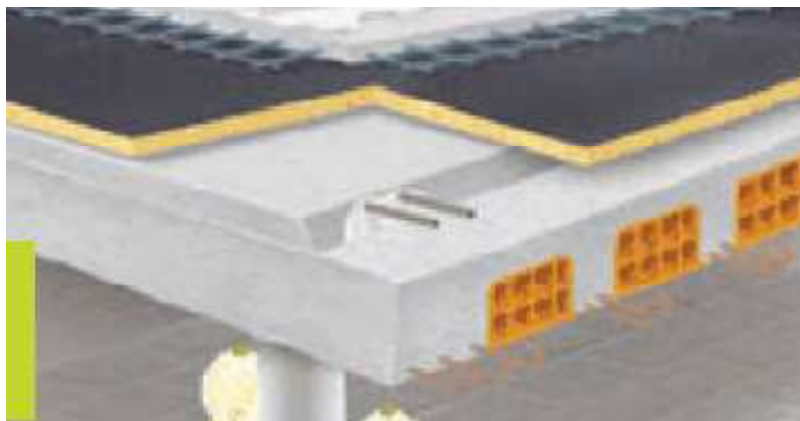
Figura 7 - Isolamento de pavimentos. [8]
