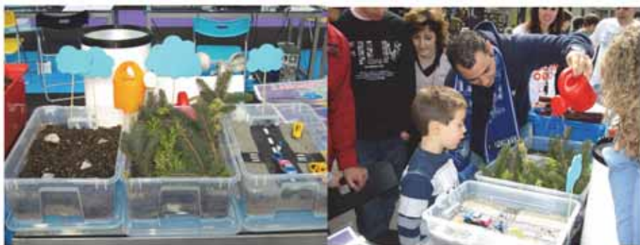
Fig. 3. Caixas de erosão, onde estão representados um solo sem vegetação e pedregoso; um com vegetação e outro impermeabilizado. Fonte: Fotos de C. Ferreira
