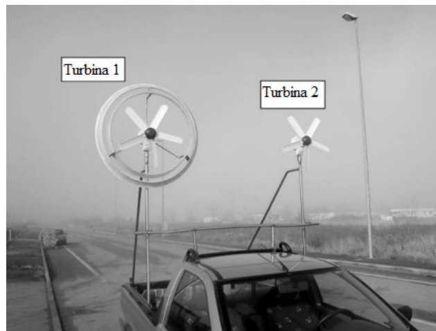
Figura 2.3.3: Modelos de campo, turbina e dispositivo com turbina. Adaptado de [8].
