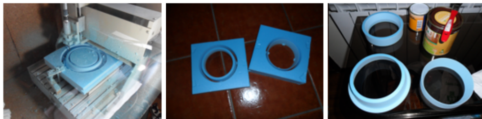
Figura 3.2.6: Algumas etapas da construção dos C-D.
