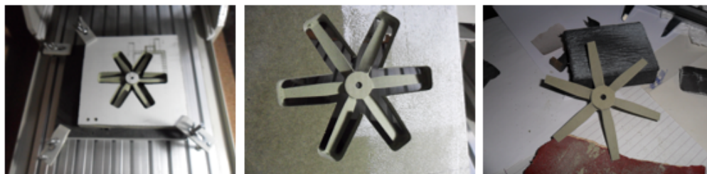
Figura 3.2.4: Sequência de algumas fases da maquinagem e do acabamento das pás.
