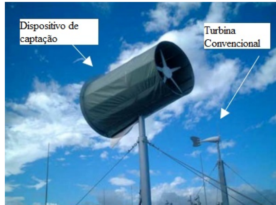
Figura 2.3.4: Modelos de campo, turbina e dispositivo com turbina em testes. Adaptado de [9].
