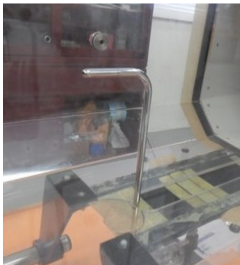
Figura 3.2.2: Tubo de Pitot para medição da velocidade do vento.
