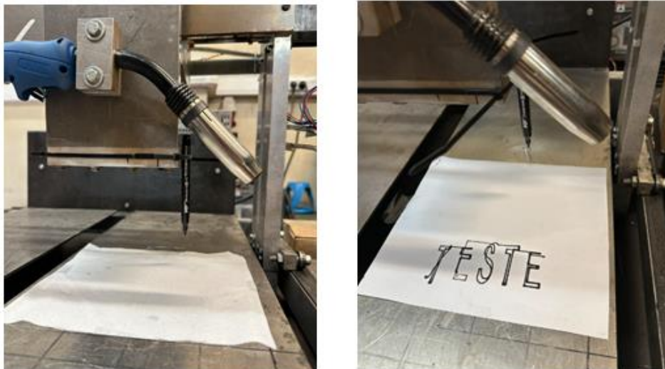
Figura 17 – Testes preliminares do maquinário com a caneta.
