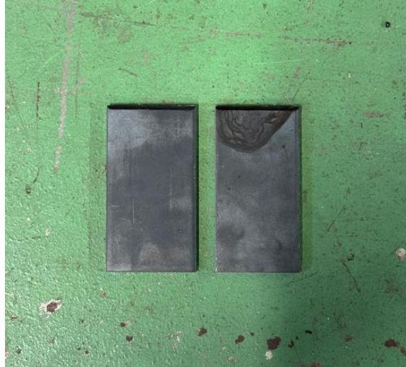
Figura 59 - Corpos de prova para ensaios não-destrutivos.
