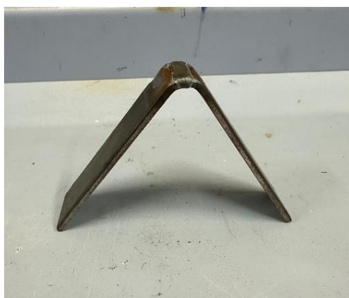
Figura 67 - Corpo de prova após o ensaio de flexão.
