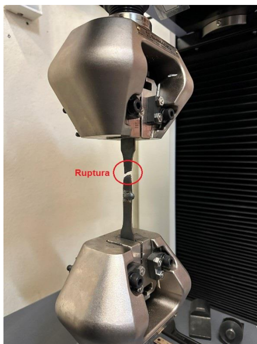
Figura 69 – Final do ensaio de tração em junta soldada, com destaque para a região onde ocorreu a ruptura.
