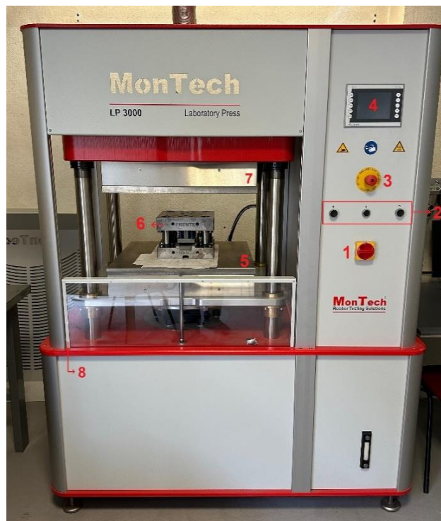
Figura 51 - Prensa hidráulica Montech LP 3000, incluindo: (1) Botão de alimentação; (2) Botões de controle do movimento; (3) Botão de emergência; (4) Painel digital de controle; (5) Carro móvel; (6) Matriz de punção; (7) Mesa fixa; (8) Barreira de proteção.
