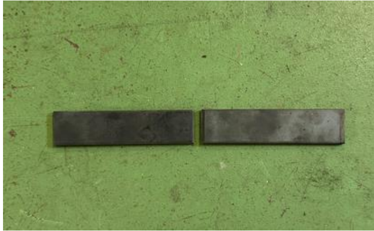
Figura 43 - Exemplo de corpo de prova para ensaio de dobramento.
